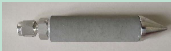
FIGUR 8. . Prenart, Supersteel sugeceller i rustfrit stål. Diameter er 20 mm. Gennemsnitlig porestørrelse er 0,05 \mu\text{m}
