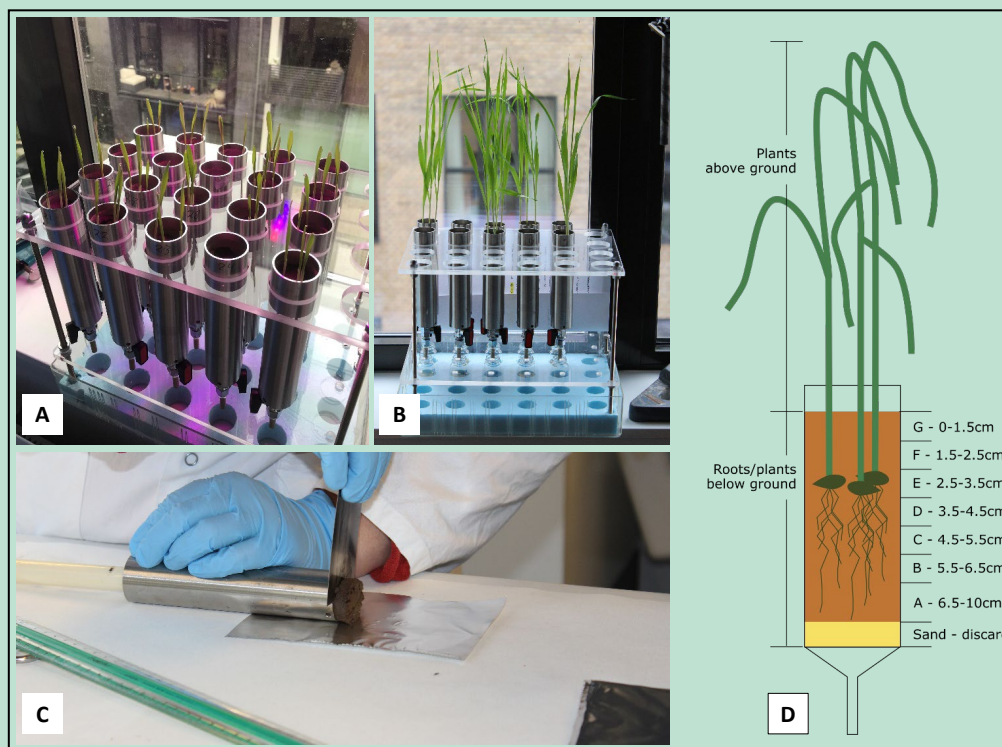
FIGUR 17. Forsøgsopstilling (Albers et al., 2022). A) Planter dag 5. B) Dag 21, opsamling af perkolat i glasvials. C) Jordkolonnerne parteres ved forsøgets afslutning efter ca. 60 dages inkubation. D) Skematisk forsøgsopstilling med angivelse af de forskellige fraktioner, der analyseres for residuale moderstoffer ved forsøgets afslutning.
