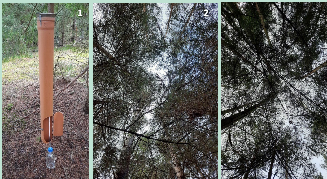
FIGUR 16. Nedbørsopsamler i Tisvilde Hegn (1) og fotos taget fra toppen af de to nedbørsopsamlere G2 (2) og G3 (3), som var placeret under nåletræsbeplantning.
