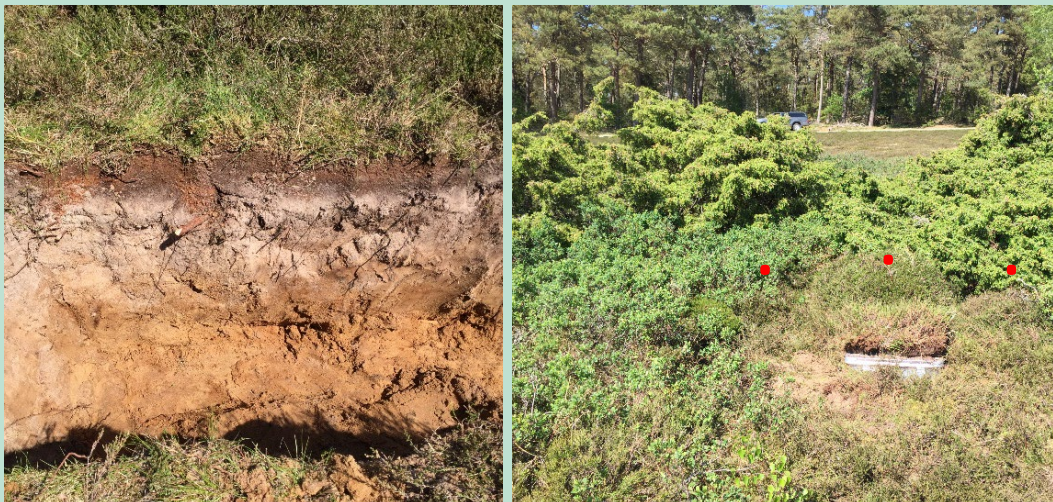
FIGUR 14. Hedelokalitet ved Asserbo Plantage (AP). Venstre: Jordprofil til ca. 70 cm under terræn. Højre: Installationens placering på arealet med angivelse af sugecellernes omtrentlige placering under forskellige typer vegetation.
