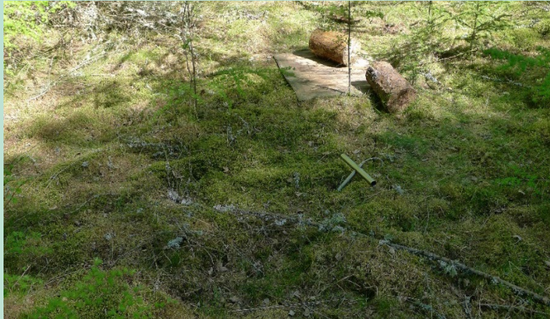
FIGUR 13. Mobil sugecelle installeret i Tisvilde Hegn. Opsamlingsflaske med påsat undertryk er under træpladen.
