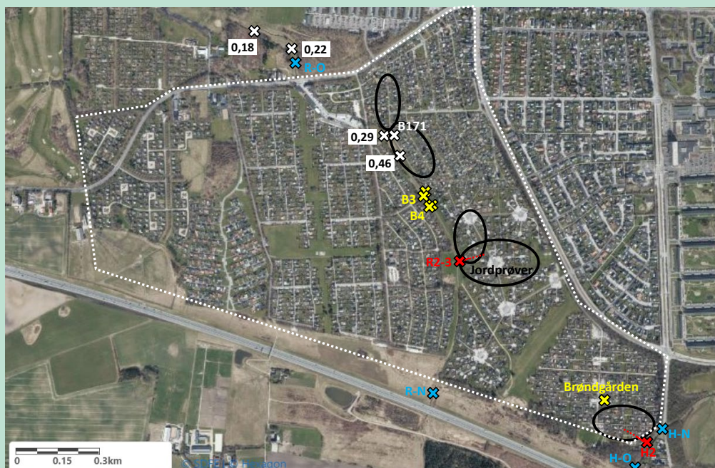
FIGUR 4. Prøvetagningssteder i kolonihaveområdet vest for Ballerup. Sorte cirkler markerer områder med prøvetagning af jord. Røde krydser angiver prøvetagningssted for gamle markdræn (retning af dræn som identificeret ved TV-inspektion af de første ca. 25 m, er angivet med stiplede linje, men ukendt, hvor langt de går ud i terrænet). Prøver af vand fra selve åerne blev taget opstrøms (-O) og nedstrøms (-N) hver af de to vandløb (blå krydser). Gule krydser angiver grundvandsboringer i sekundært sandmagasin. Ved B3 og B4 er der både prøvetaget fra filtersatte boringer og niveau-specifikke rammeboringer, ved Brøndgården kun rammeboring. Hvide krydser angiver boringer i underliggende kalkmagasin. For de fire indvindingsboringer er DMS-koncentrationen i \mu\text{g/L} i 2018 angivet. Den stiplede hvide linje angiver kolonihaveområdets udbredelse.
