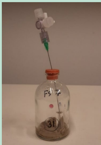
FIGUR 18. Endelig, ilttæt opsætning med lyserød iltsensor, som kan aflæses gennem glasset.
