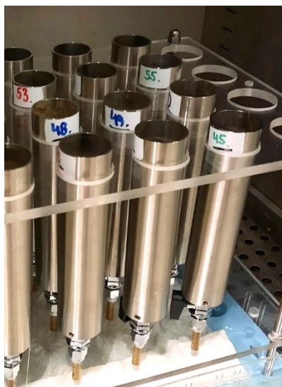
Søjleforsøg til undersøgelse af dannelse og udvaskning af DMS fra cyazofamid.
