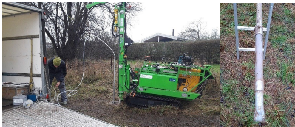
Niveauspecifik prøvetagning ved hjælp af nedramning af vandrør påsat en sugespids (spids med filter)
