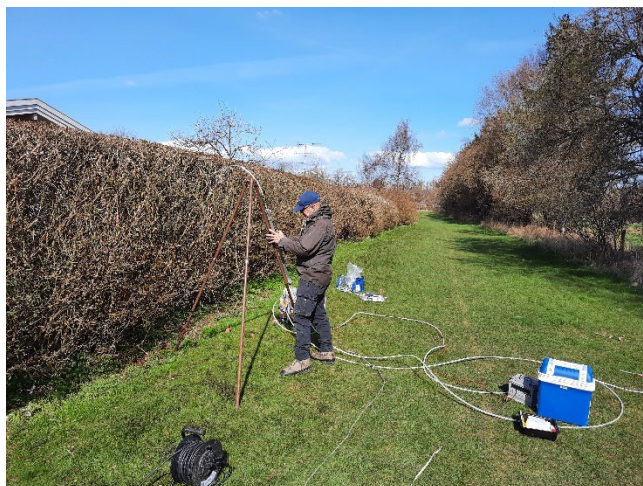
Niveauspecifik prøvetagning til grundvandsdatering i filtersat boring vha. to pumper
