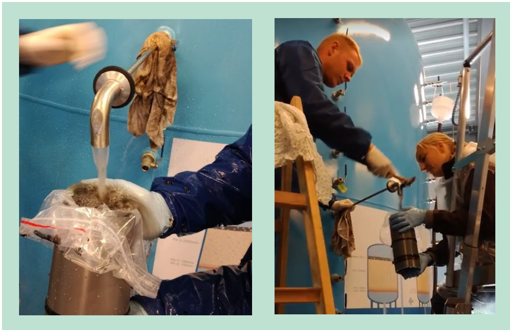
FIGUR 5. Udstyr og filtermedieprøvetagning fra lukket filter.
