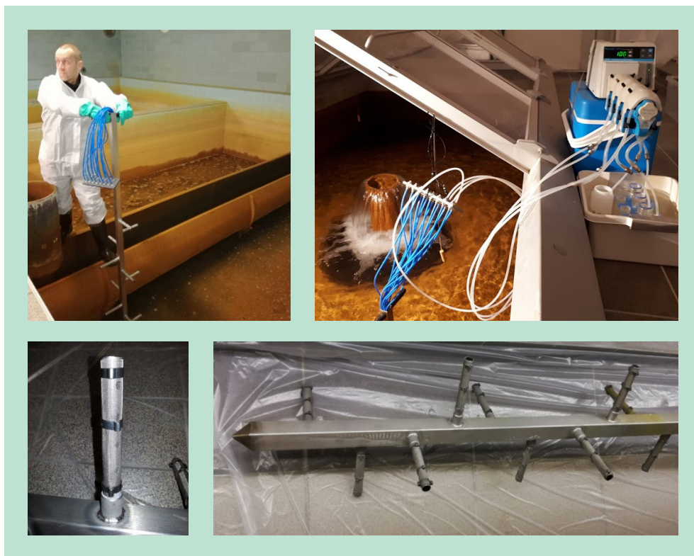
FIGUR 3. Juletræet. Øverst til venstre: klar til nedsætning. Øverst til højre: isat filter og koblet til slangepumpe. Nederst til venstre: gren med filter. Nederst til højre: bunden af Juletræet og illustration af grenenes placering.
