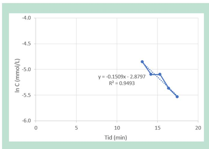
FIGUR 5. Beregning af hastighedskonstant for ammoniumfjernelse.
