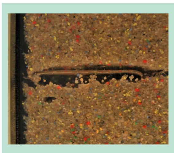
FIGUR 19. Kravlende sprække med luft og vand.
