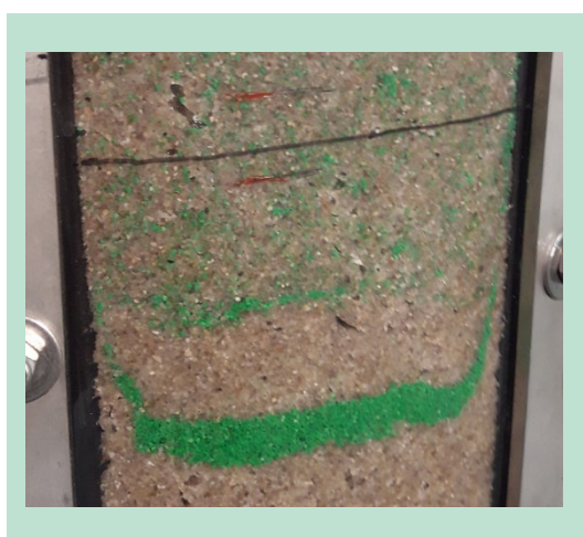
FIGUR 21. Nedsynkning af grønfarvet sand (det farvede lag var oprindeligt placeret ved den sorte streg).
