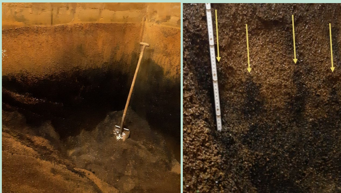
FIGUR 8. Venstre: Frigravning af filtervæg, hvor farveskiftet fra rødt til sort kan ses i ca. 50-60 cm's dyb-de. Dette blev observeret i hele filteret. Højre: Mørke kanaler, der går fra det nederste sorte filterlag og op i det rødlige filterlag. Højden af kanalerne er typisk 10-25 cm.
