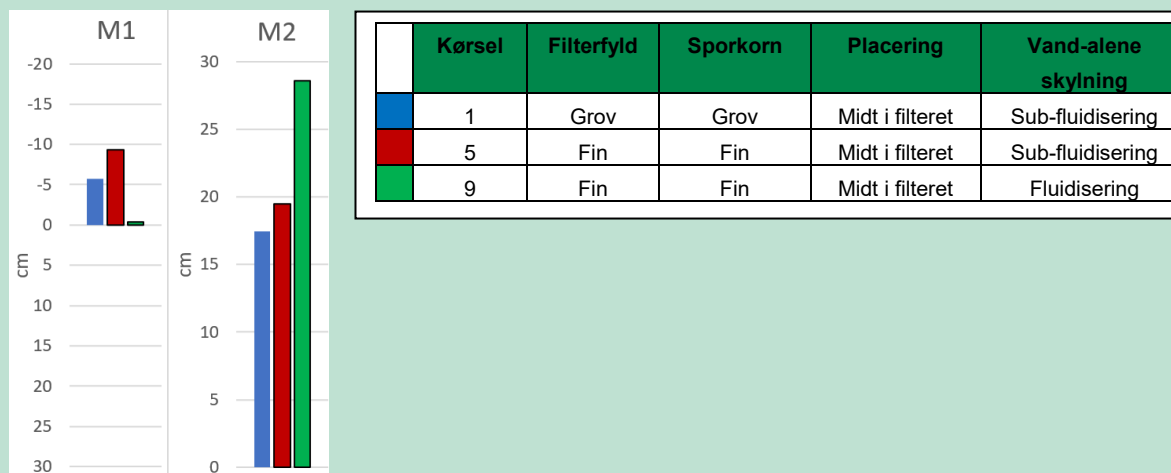
FIGUR 26. Farvet grovsand i grovsand fyld (blå) og farvet finsand i finsand fyld (rød og grøn), placeret midt i filteret. M1 er middel flytningsafstand og M2 er standardafvigelsen af det farvede sands dybdefordeling.
