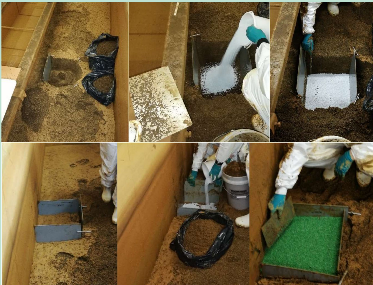
FIGUR 10. Opbygning af de to forsøgsfelter på Børkop Vandværk forud for returskyllningen. Øverst vises Felt A ved skyllevandsrenden midt i filteret og nederst vises Felt B ved filterkanten.
