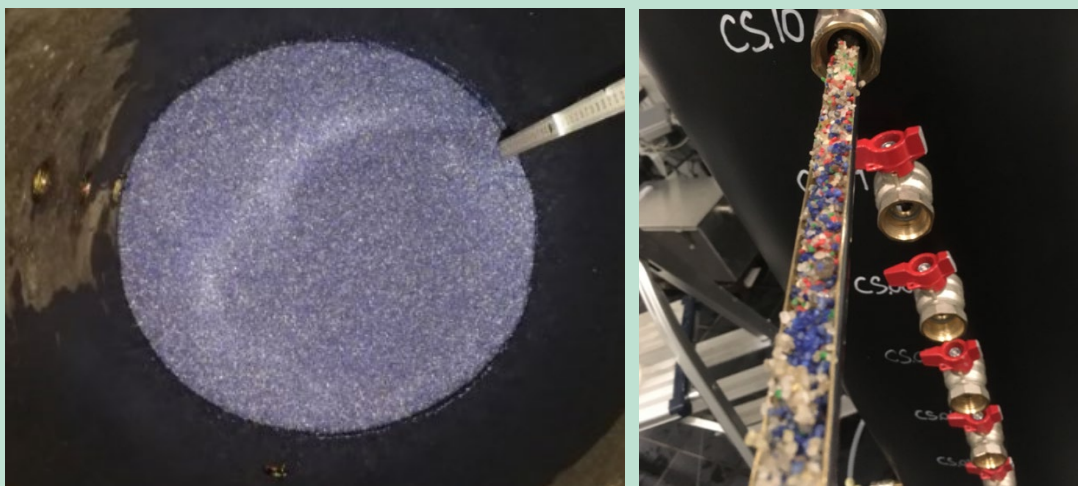
FIGUR 9. Pilotkolonne med ilagt blå farvet sand på toppen, før test med 3 min vandskyl 30 m/l, venstre. Højre billede viser niveaubestemt prøvetagning med prøvetagningsspyd gennem prøveporte i siden af pilotkolonnen efter returskylning.
