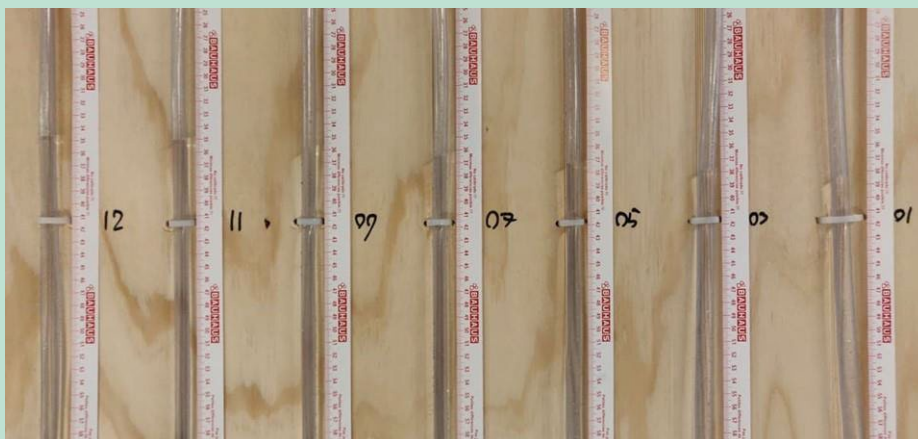
FIGUR 10. Forsøgsopstilling med stigerørtavle, hvor hver af de syv stigerør er forbundet til et kolonneudtag i forskellige dybder (Poulsen, A. & Steinfeldt, C., 2019. Bachelorprojekt, side 40, Aarhus Universitet).
