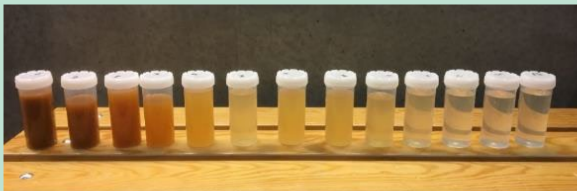
FIGUR 8. Prøver udtaget af returskyllevandet i skyllevandsrenden med 30 sekunders interval startende fra venstre.
