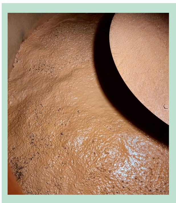
FIGUR 32. Filteroverfladens øverste centimeter var fyldt med okker ved tømningen af filteret.
