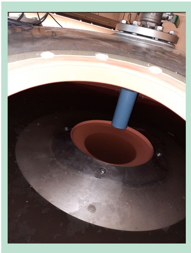
FIGUR 3. Ledepladens placering i forsøgsfilteret.
