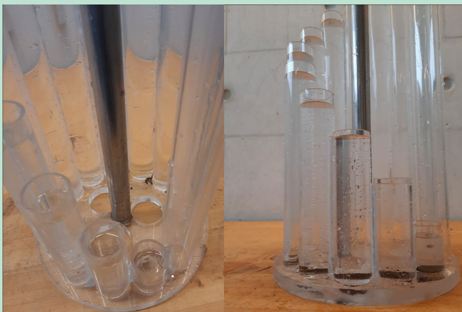
FIGUR 12. Fotos der illustrerer pibeorglet efter forsøgene henholdsvis uden filtermaterialer og med fines i nogle af rørene.
