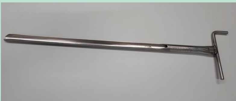
FIGUR 4. Prøvetagningsspyd til udtagning af sandprøver.
