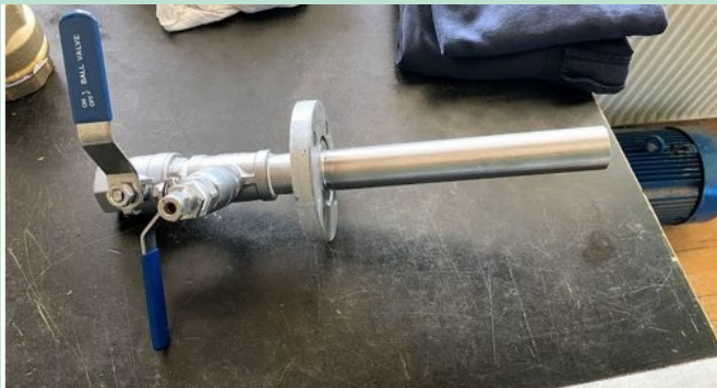
FIGUR 3. Prøvetagningshane med 1" ventil inden montering.
