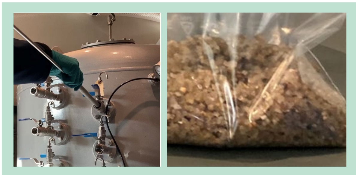
FIGUR 26. Udtagning af sandprøve med spyd fra 1" ventil (tv). Sandprøve udtaget og lagt i pose (th).
