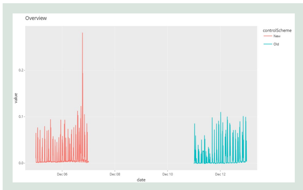
FIGUR 15. Grafen viser rå N 2 O produktionsdata fra den nye styring (rød, 5. og 6. dec.) og den traditionelle styring (blå, 11. og 12. dec.) efter weekenden.
