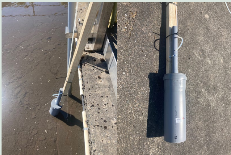
FIGUR 9. Prøveudtagningsslange monteret på den flydende anordning (venstre). Placering af målepunkterne i procestanken (højre).
