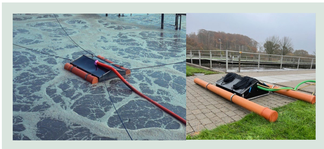
FIGUR 1. Design af prototype af flyderen med korte pontoner (venstre) og forlængede pontoner (højre).
