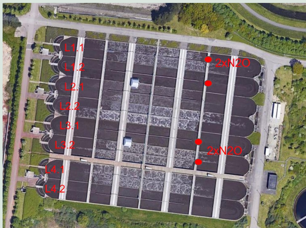
FIGUR 12. Sensorplacering i Avedøre Renseanlæg.
