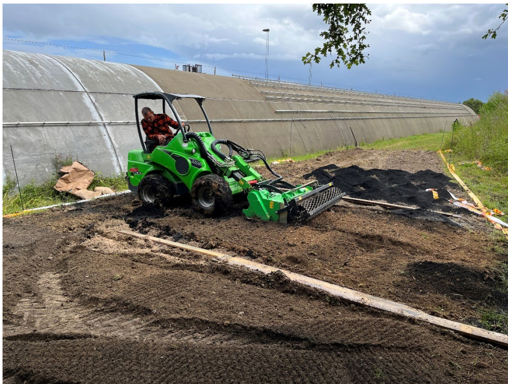
Alle behandlingsfelter fræses for at sikre homogenitet og iltende forhold.
