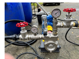
Kavitationspumpe, der danner mikro- eller nanobobler i væskestrømmen. Foto: K/S OilRem
