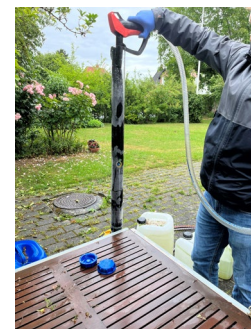
Kolonneforsøg med Graphysorber som filtermateriale. Foto: K/S OilRem
