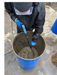
Barrel-test PFAS, olie m.m. danner et skum på overfladerne Foto: K/S OilRem
