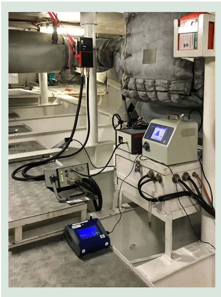
FIGUR 16. Billede af det anvendte fortyndings- og partikelmåle-udstyr.
