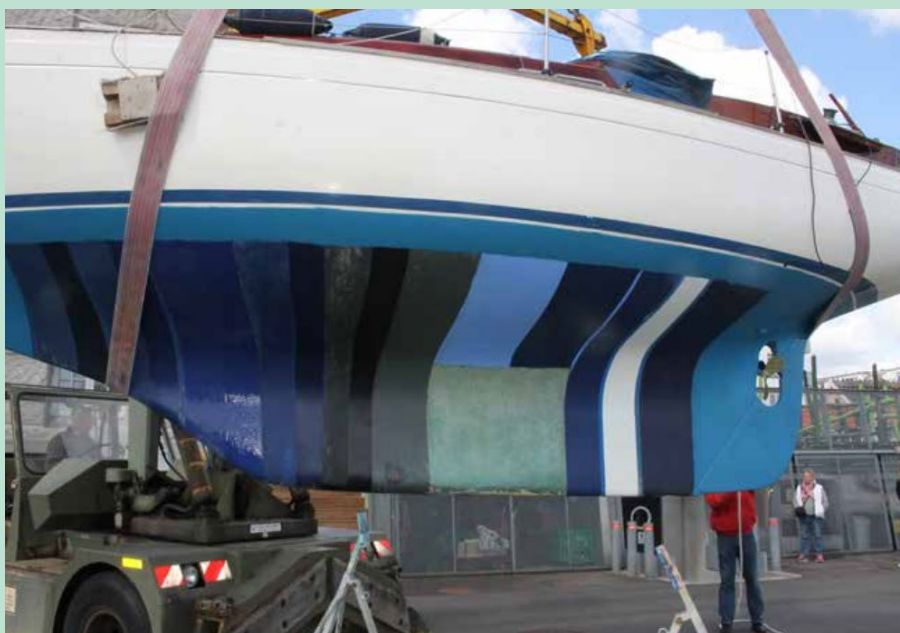
FIGUR 2-3 Testbåd med påføring af forskellige malinger (fra Rasmussen, 2021).
