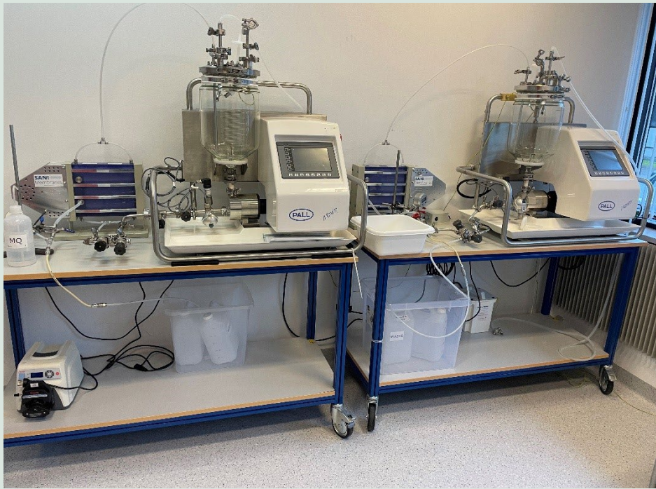
FIGUR 5-1. SANI-Membranes Vibro@-Lab3500 enheder anvendt til dia-vask af neddelt polymer med Purified Water.
