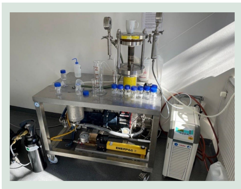
FIGUR 6-4. Labstak M20 RO forsøgsanlæg fra Alfa Laval til etablering af designgrundlag for RO enhed til genvinding af Gly-Phe.
