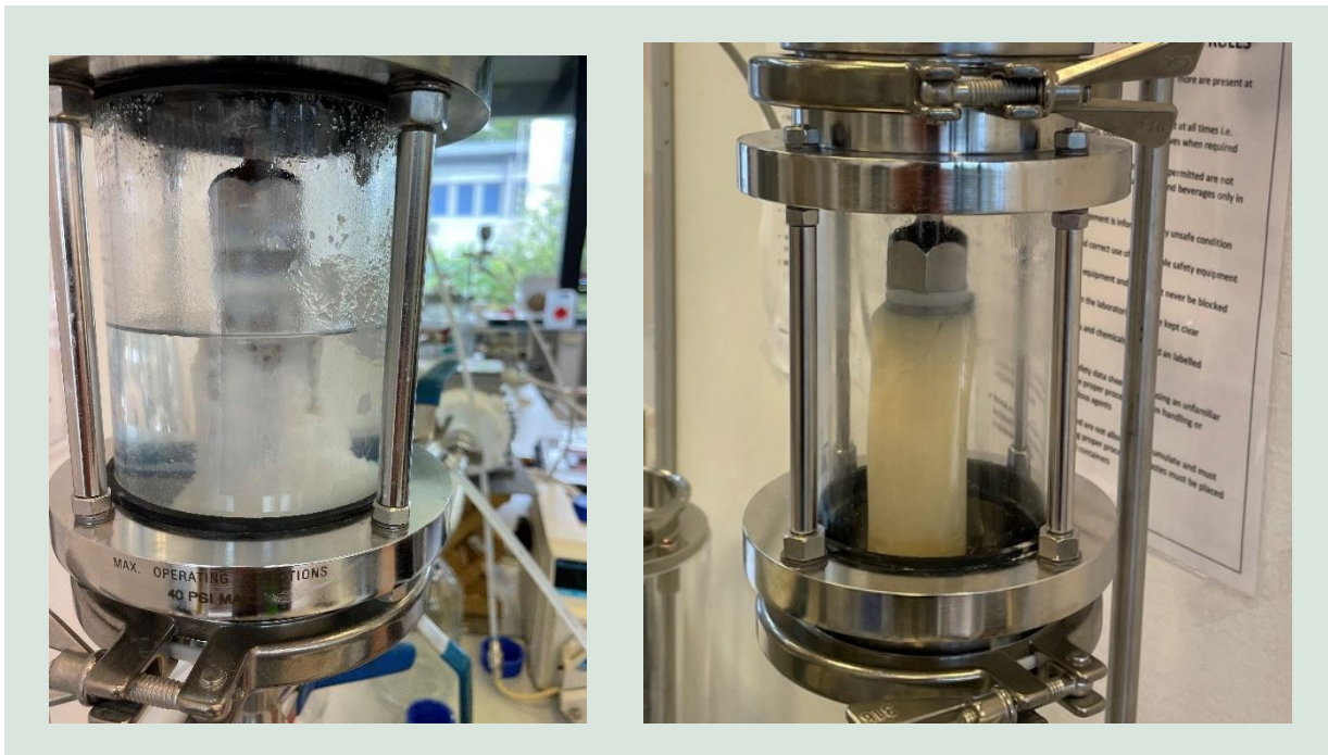
FIGUR 3-9. Til venstre foto fra indledende forsøg med tæt membran, hvor filterkagen ikke kunne fastholdes under afdræning. Til højre filterkagen på 5,5µm hydrofob membran efter frafiltrering af synteseolie med henblik på genbrug.
