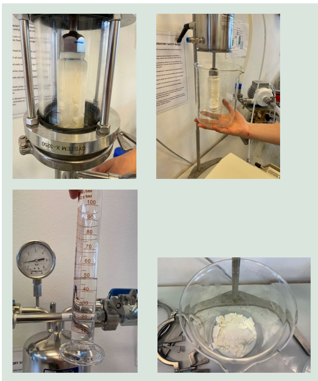
FIGUR 4-1. Fotos af forskellige faser af råpolymer filterkagen under/efter vask med EtOH.
