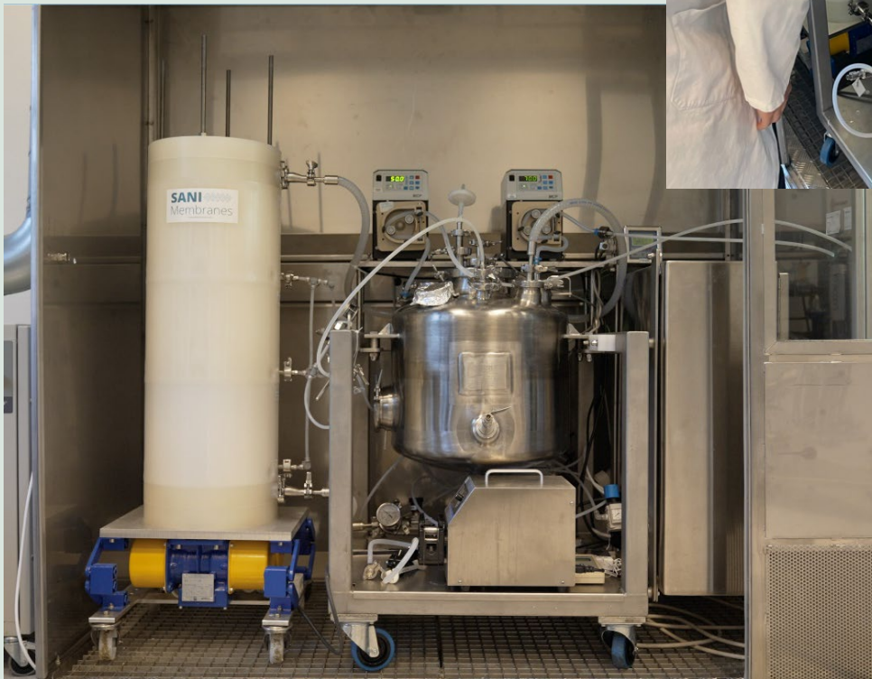
FIGUR 4-6. Vask ved diafiltrering i Vibro-filtreringsanlæg 0,35 m 2 i laboratoriet øverst til venstre og den opskalede filtreringsopstilling 7,5 m 2 nederst og til højre.
