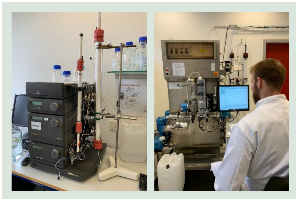
FIGUR 6-8. Affinitetskromatografiprocessen i laboratorieskala (til venstre) og i opskaleret skala (til højre).
