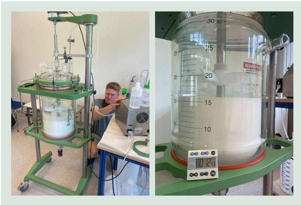
FIGUR 6-1. Udvaskning af overskud af Gly-Phe fra koblet resin med Purified Water med henblik på genanvendelse.
