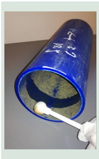
FIGUR 11. Udtagning af swab-prøve fra afskåret stykke af PEM-rør, testrig.
