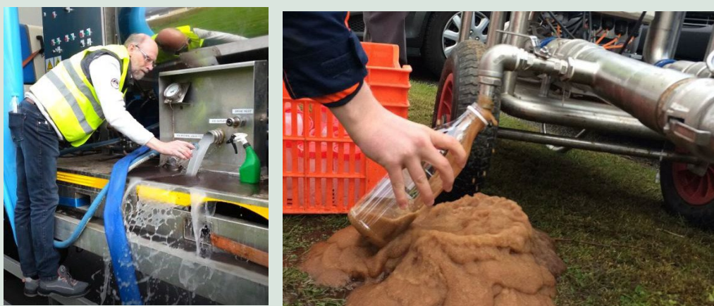
FIGUR 10. Udtagning af is-/vandprøver direkte fra isbilen (venstre) og ved udløb vandledning (højre).
