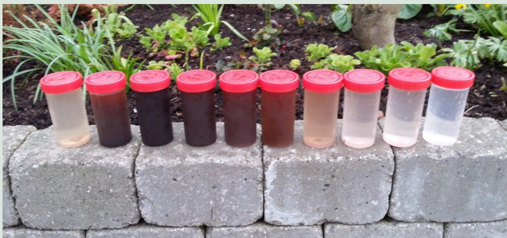
FIGUR 9. Is-/vandprøver fra udløbet, udtaget for hvert 30 s fra Søbakkevej, Aarhus.
