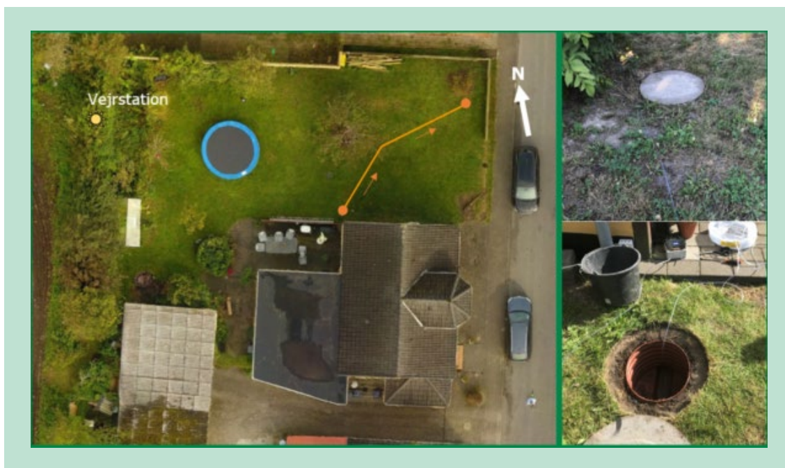
FIGUR 4.472. Eksempel: Placering af ca. 11,8 meter kloakstreng (ø110 mm PVC, orange linje) og vejrstation (venstre). Fotos af hhv. nedstrøms (øverst) og opstrøms (nederst) brønd, ø315 PVC med betondæksler (indsatte fotos til højre). Differenstryksslangen er ført over jorden.
