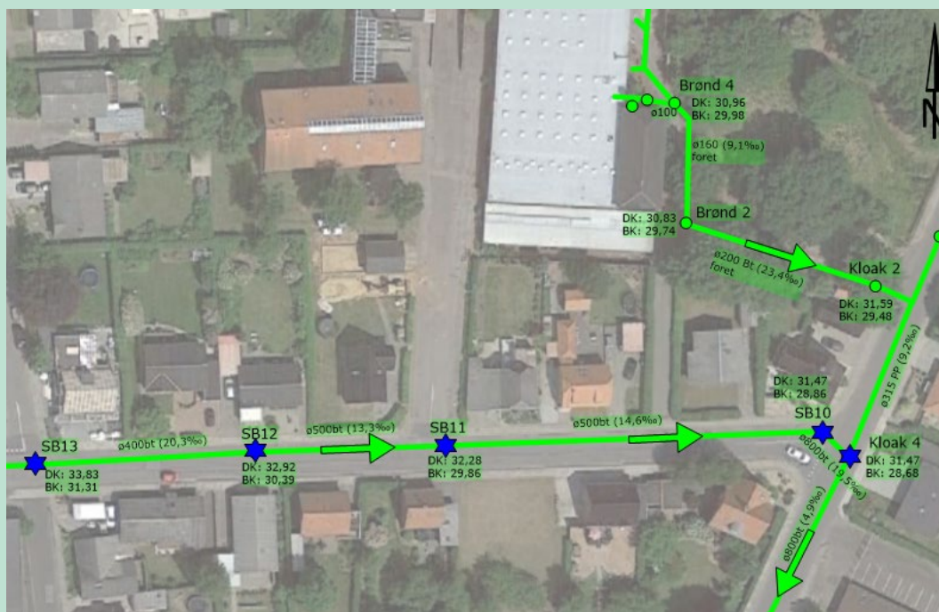
FIGUR 4.261. Kloakstrækning i Videbæk, med karakterisering af forureningstransport i gasfasen, fra hovedkloakken (Kloak 4) og mod vest, modsat vandets strømningsretning. De blå stjerner markerer de prøvetagne brønde.
