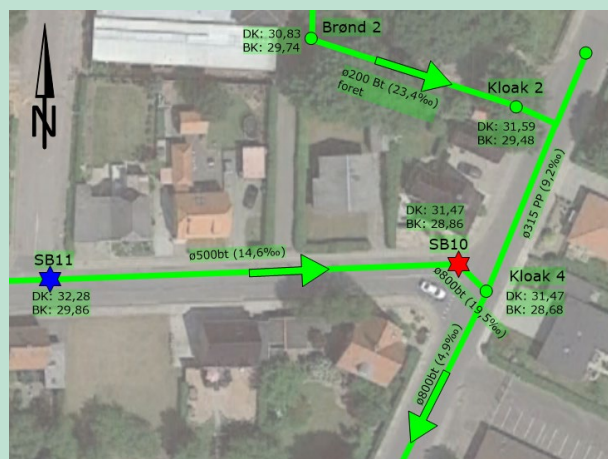
FIGUR 4.650. Kloakstrækning på sidegrenen i Videbæk, hvor der er udført et sporgasstudium med PFT-sporgasser. Kilde med blå sporgas er placeret i SB11 og kilde med rød sporgas er placeret i SB10. Begge gasser er opsamlet/målt i duplikat i begge brønde. Gennemsnitlige resultater (ng/sampler), normeret til en opsamlingsperiode på 14 dage er indsat i tabel.
