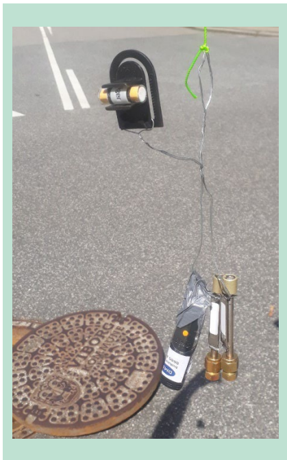
FIGUR 40. Målecluster bestående af ét ORSA-rør, to ATD-rør og én T-RH-logger.
