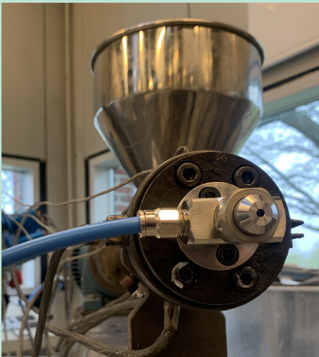
FIGUR 20. Spraysystem monteret på ekstruder
