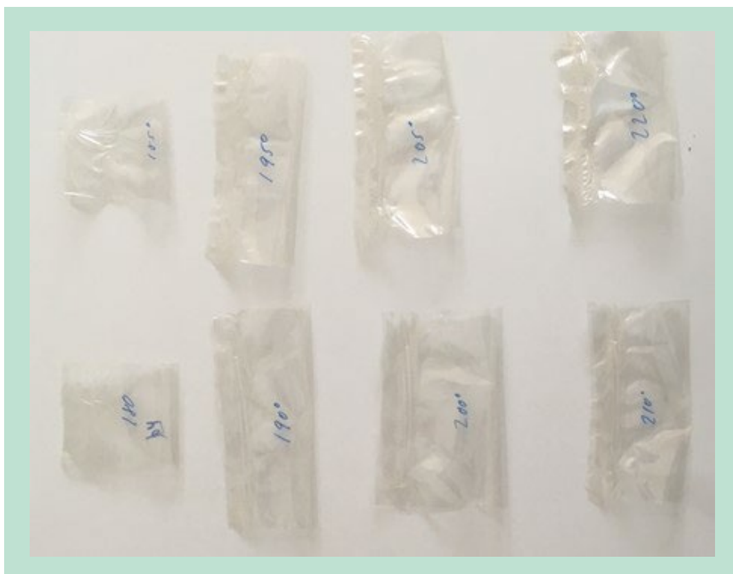
FIGUR 12. PET-film svejst ved forskellige temperaturer mellem 180-220°C
