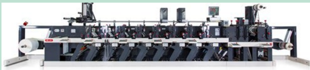
FIGUR 45. Flexotryk-linje. Hver farve overføres fra hver sin trykstation.
