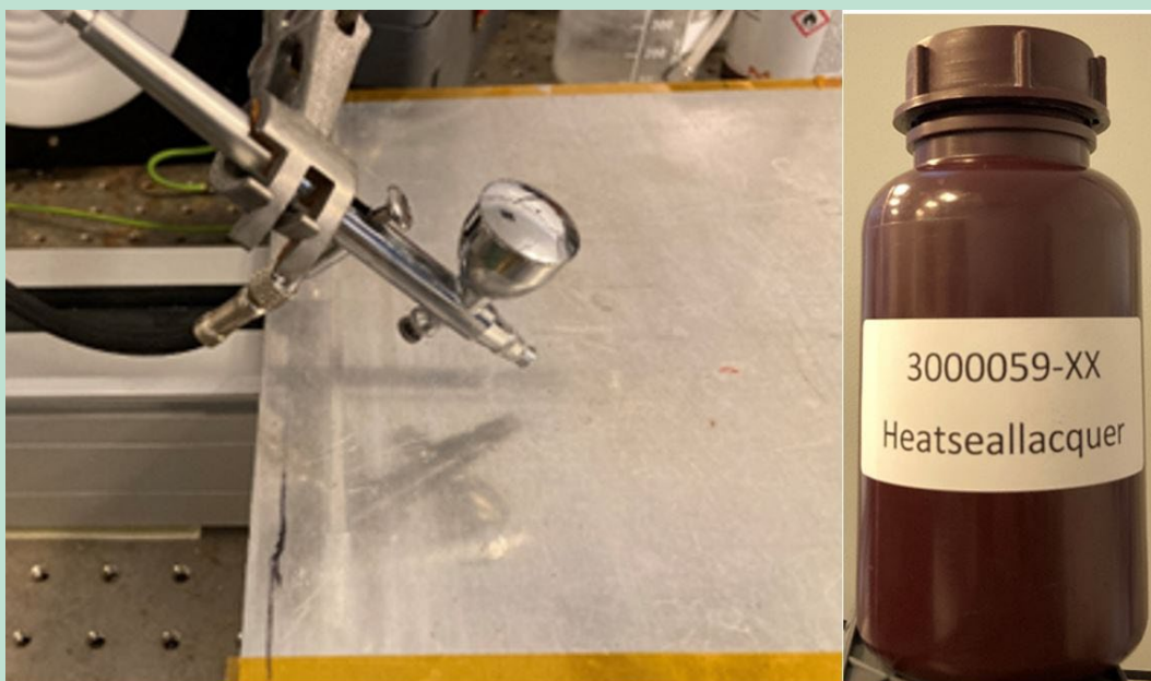
FIGUR 50. Sprøjtepistol og svejselak brugt forsøgene
