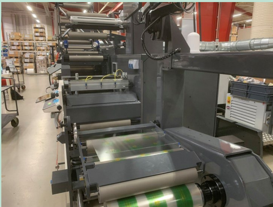
FIGUR 39. Trykning af PET-film hos Nilpeter af svejselag baseret på svejselak
