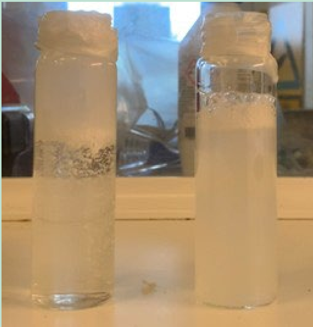
FIGUR 23. Dispersion af PE-partikler i vand (venstre) og PEG-modificerede partikler i vand (højre) 5 sekunder efter udtrystning. PEG-modificerede partikler holder sig svævende i timevis, mens de oprindelige PE-partikler øjeblikkeligt stiger til overfladen
