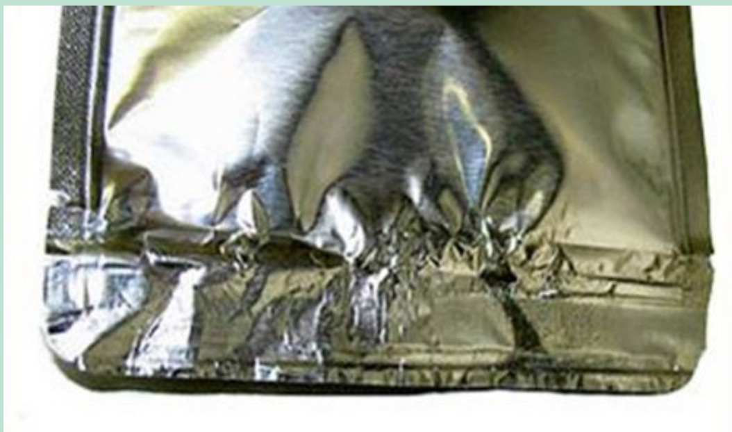
FIGUR 41. Svejserynkninger på metalliseret PET-film
