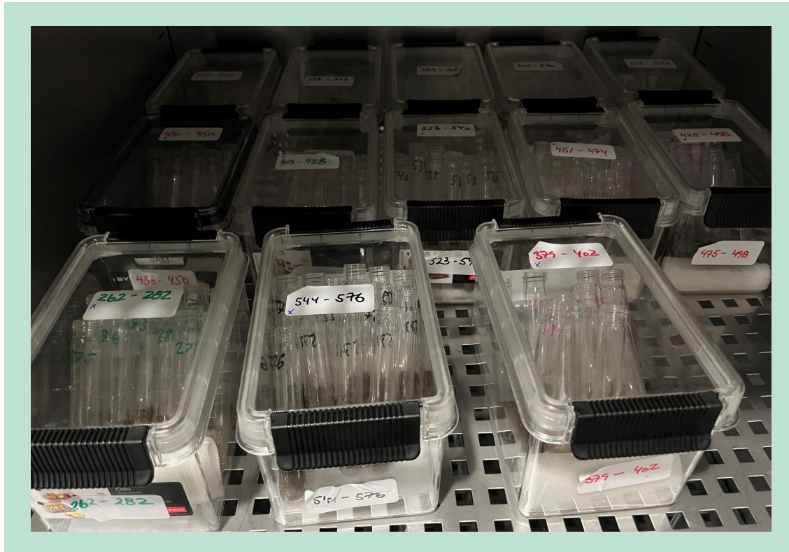
FIGUR 18. Rør med pesticid-spiket jord blev inkuberet i op til 52 uger ved 20°C i fugt-mættede men ilt-permeable plastkasser.
