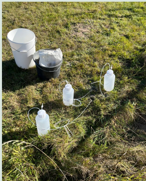
FIGUR 12. Foto af opsamlings-/vakuumflasker over terræn ved terrænnære porevandsprøver. På den konkrete sag, er der installeret sugeceller i tre forskellige dybder (0,5; 1,0 og 1,5 m u.t.).
