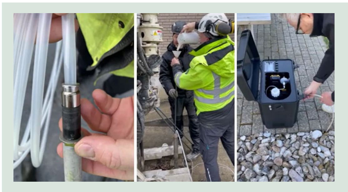
FIGUR 13. Til venstre: DualTube-sugecelle med dobbeltslange. Midt for: Kvartsmel tilsættes omkring sugecellen via et rør (her 16 m u.t.). Til højre: Dobbeltslangen forbindes til den automatiserede prøvetagningsenhed (SRO) med opsamlingsflaske og vægt.
