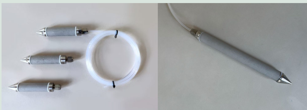
FIGUR 3. Stålsugeceller produceret af DMR. Længden af sugecellerne er hhv. 110 mm og 200 mm. Den ydre diameter for begge er 19 +/-0,5 mm. Sugecellerne har et porøst areal på hhv. ca. 40 og 90 cm 2 og en porestørrelse på 0,2-0,5 µm.
