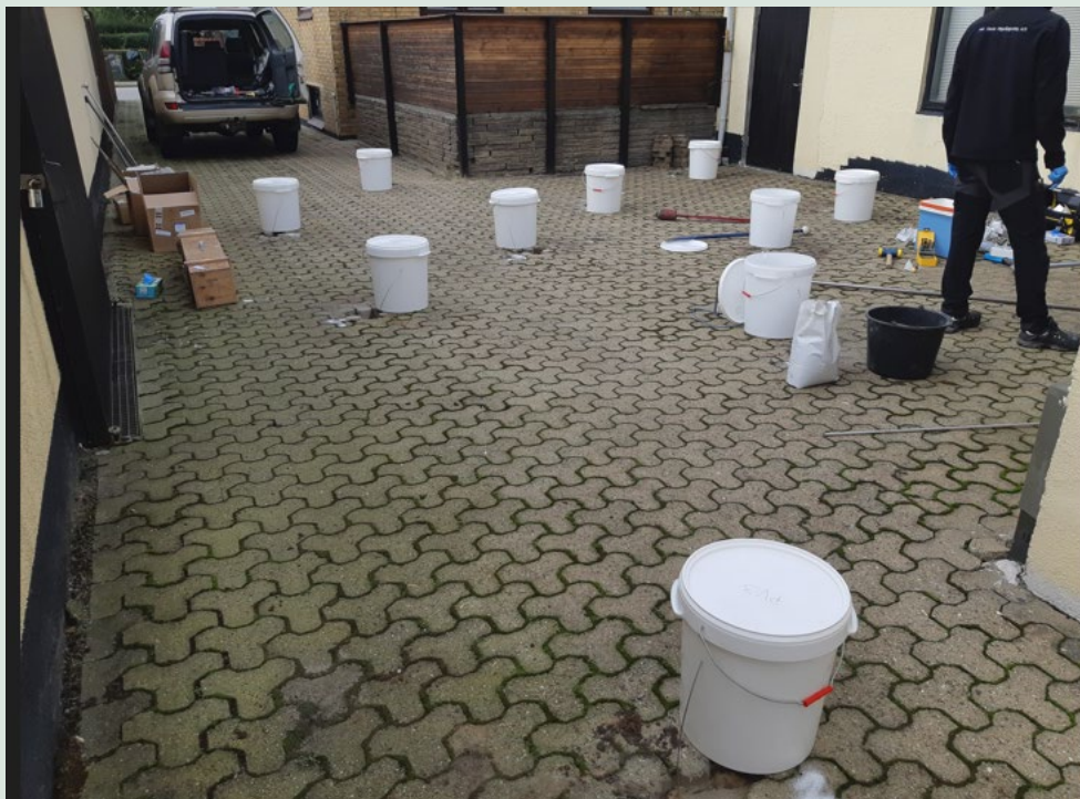
FIGUR 17. Installation af sugeceller på lokalitet 1. Vakuumflaskerne opbevares i de hvide spande.
