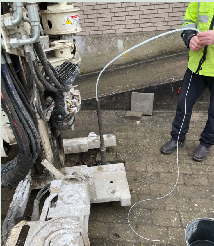
FIGUR 26. Foto af etablering af DT2 ved læsserampen i dybden 5 m u.t. med Geoprobe®. Sugecellen blev monteret i ønsket dybde via specialdesignet dorn på Geoprobens arbejdsrør. Dobbeltslangen ses stikkende op af arbejdsrøret.
