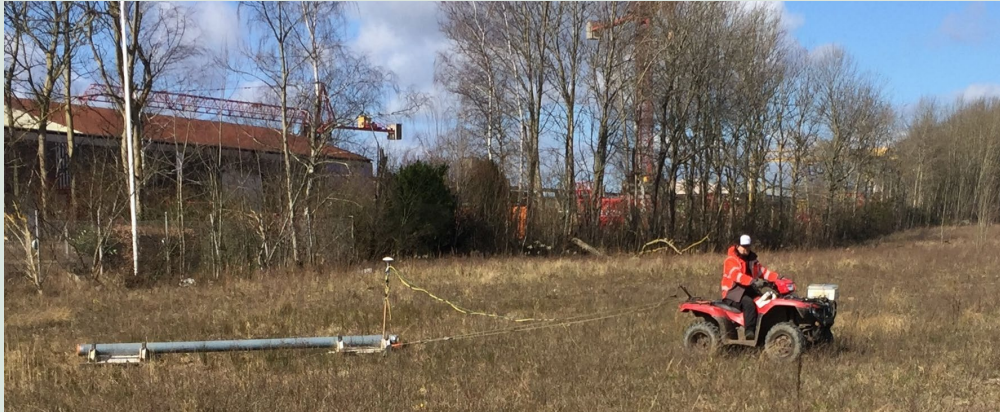
FIGUR 9. Kortlægning med DualEM-421s 11 . Instrumentet trækkes ca. 4 m efter ATV'en, som også bærer batteri og laptop. GPS-antennen er monteret på instrumentet.
