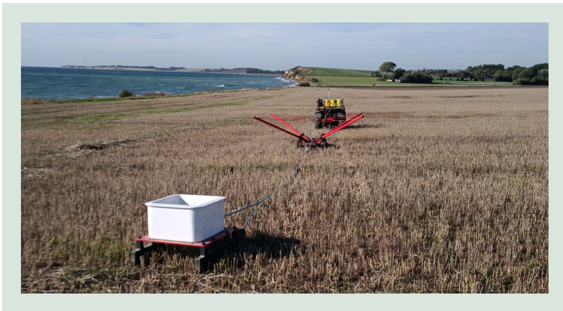
FIGUR 2. tTEM udstyr: en ATV trækker sender- og modtagerspoler 2 .
