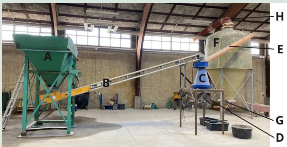
FIGUR 7. Opstilling hos RGS Nordic af aspirator med cyklon til at frasortere finmaterialet fra den neddelte beton.
