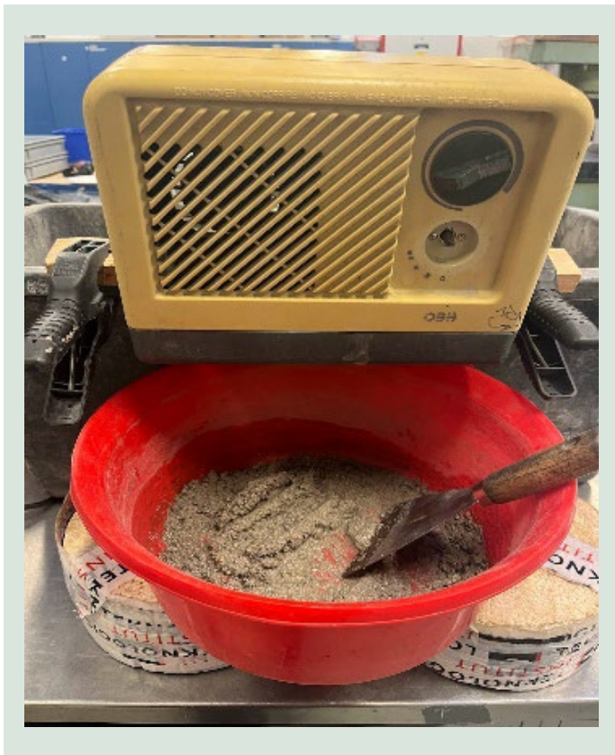
FIGUR 14. Billede af forsøgsopstillingen for måling af desorptionsisoterm. En kendt mængde vådt tilslag (nederst i rød beholder) opvarmes gradvist via et varmeelement (øverst). Tilslagets omrøres kontinuerligt, og tilslagets masse måles ligeledes kontinuerligt.
