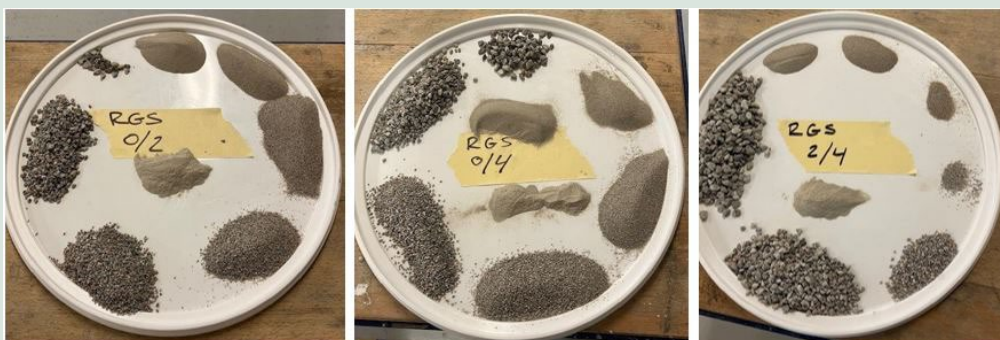
FIGUR 5. Oversigt over kornsammensætningen af de forskellige nedknuste prøver fra RGS Nordic efter sortering via sigtetårn. På malertapen på hvert billede er der angivet det angivne størrelsesinterval fra RGS Nordic (0-2 mm, 0-4 mm samt 2-4 mm) opnået via sorterværk.
