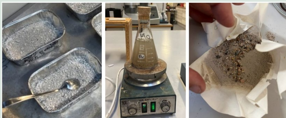
FIGUR 15. Billeder af nedknust betonprøve før (venstre) under (midt) og efter syre (højre) i testen for bestemmelse af cementindhold i prøven.
