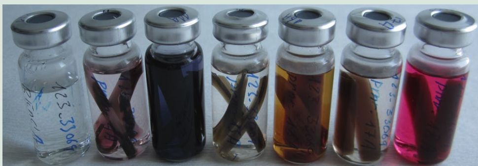
FIGUR 2. Farver af migrationsvæsker efter 72 timer og 37 °C. Billedet viser fra venstre mod højre følgende prøver: blindprøve (farveløs væske), brille 4 (lyserød væske), brille 11 (mørkeblå væske), brille 13 (farveløs væske), brille 16 (kraftig brun/orange væske), brille 17 (svag lys rød væske) og brille 18 (rød væske).
