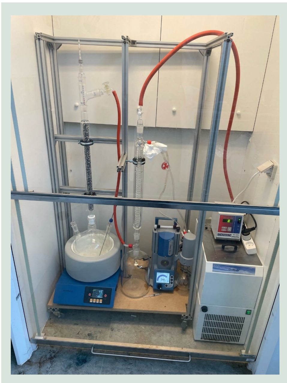
FIGUR 3. Billede af det opskalerede destillationsanlæg. Der blev, efter at dette billede blev taget, foretaget små ændringer, som sikrede, at den fordampede ethanol ikke blev ført gennem de røde slanger, men i stedet gennem glastrør.
