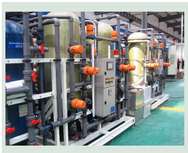
FIGUR 25. Kommercielt ionbytningsanlæg med flere kolonner og ventiler.
