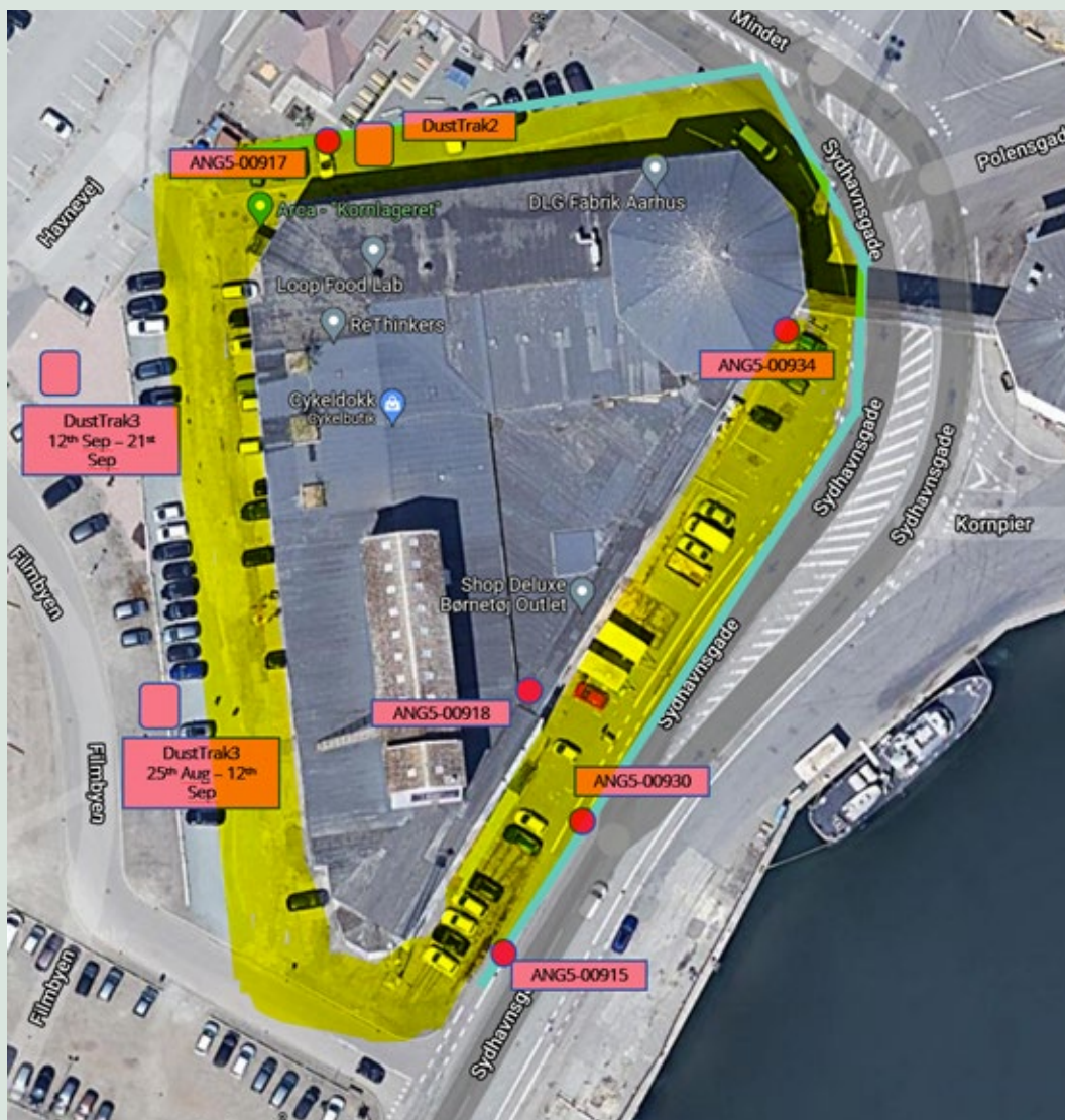
FIGUR 21. Placeringen af DustTraks (firkanter) og AirNode sensorer (cirkler) anvendt til analysen, samt vejarealet, hvor CMA blev spredt.
