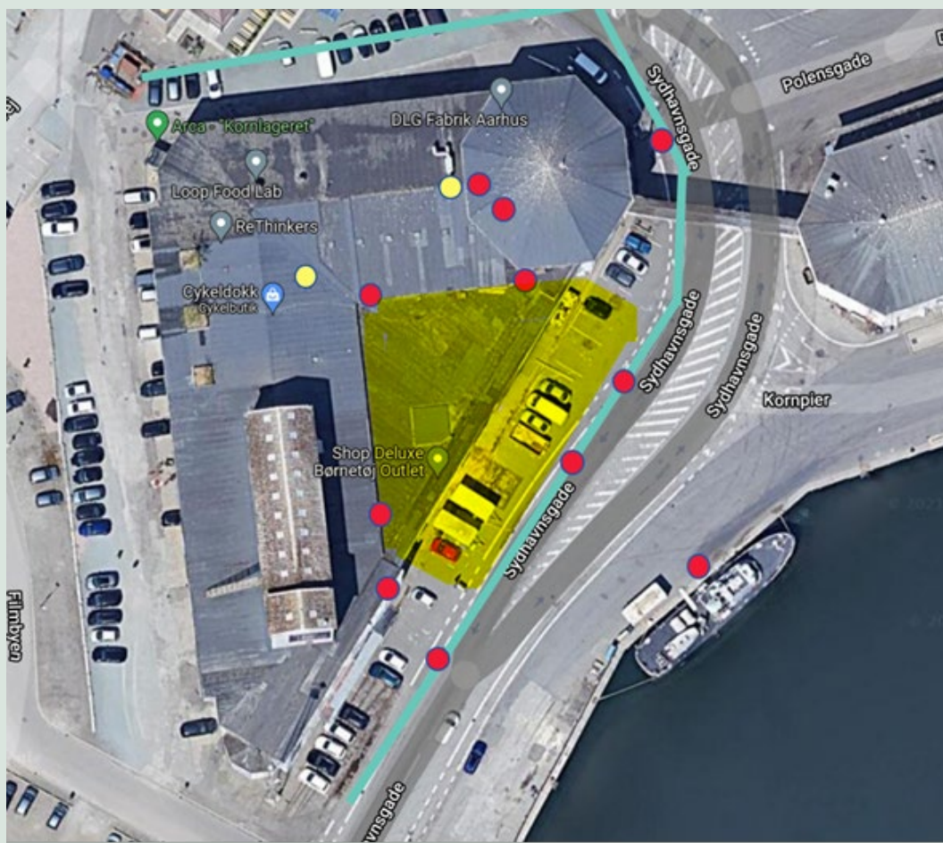
FIGUR 18. Placeringen af de sensorer, der anvendes til analysen. Luftkvalitetssensorerne er repræsenteret af røde etiketter, mens støj og vind er repræsenteret af gule etiketter. Området, hvor de fleste byggeaktiviteter fandt sted, er fremhævet med gult.
