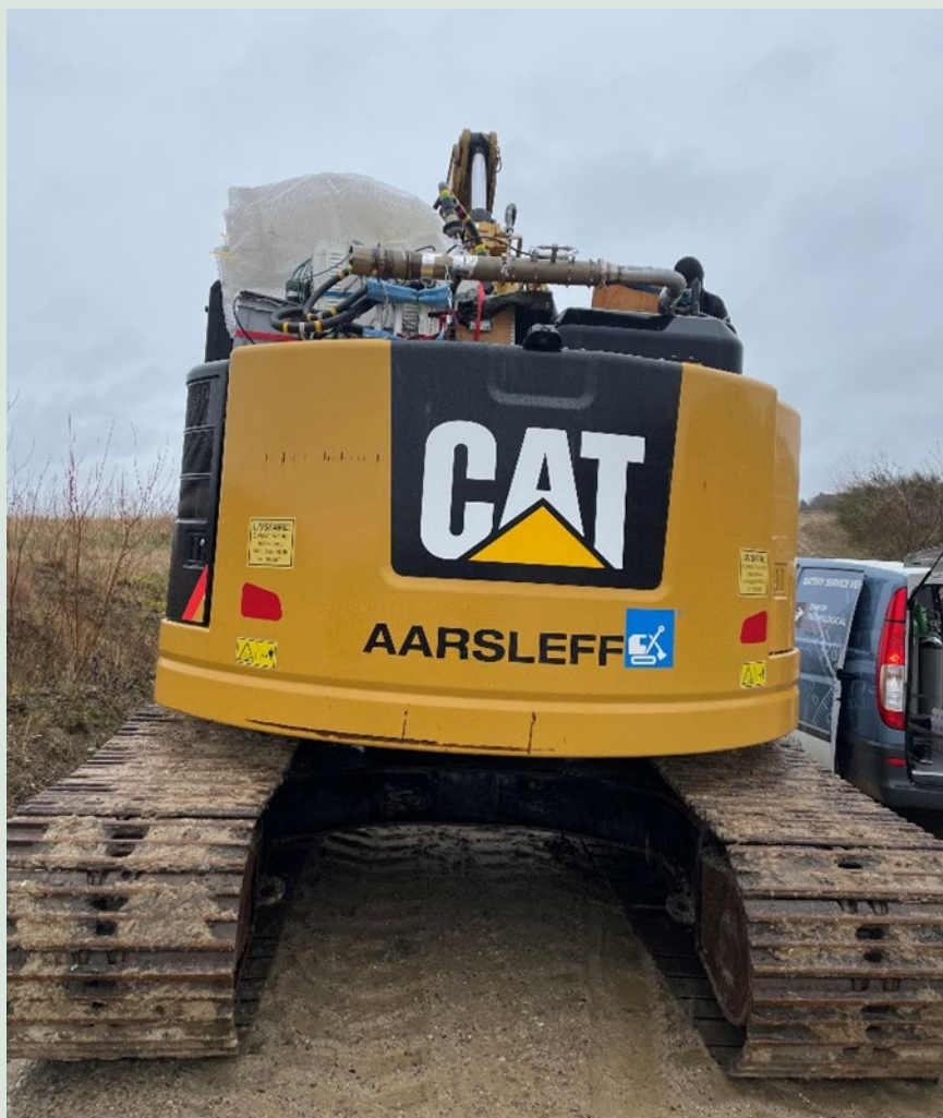
FIGUR 25. PEMS-udstyr monteret på gravemaskine.
