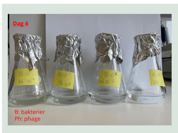
FIGUR 64. Udsnit af prøver ved forsøg dag 4. Væsken var klar i alle prøver inkl. B 10 0 -prøver med den højeste koncentration af blågrønalger tilsat.
