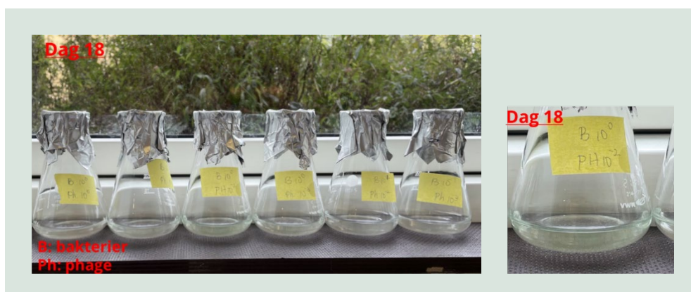
FIGUR 66. Eksempel på prøver ved forsøg dag 18. Væsken begyndte at have et svagt grønligt skær i B 10^0 -prøver med den højeste koncentration af cyanobakterier.
