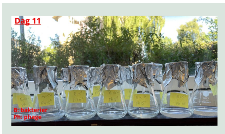
FIGUR 65. Udsnit af prøver ved forsøg dag 11. Væsken var klar i alle prøver inkl. B 10^0 -prøver med den højeste koncentration af blågrønalger tilsat.
