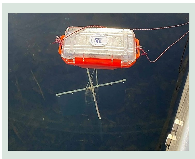
FIGUR 50. Måling af strømningsretningerne og -hastighederne med mobiltelefon placeret i en vandtæt beholder.
