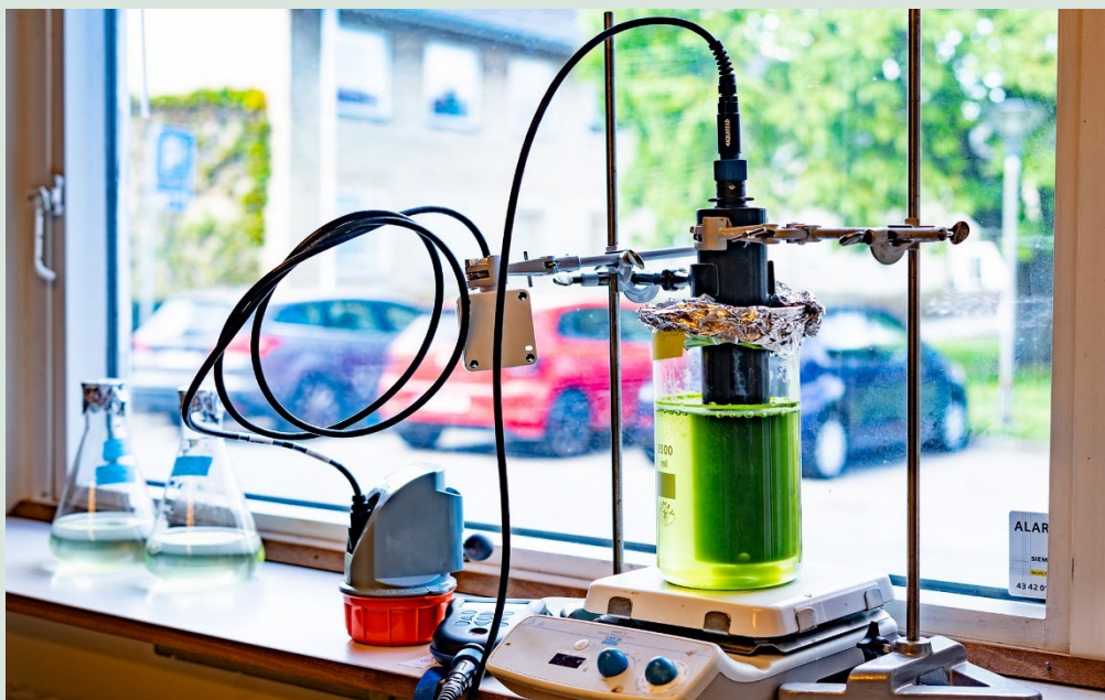
FIGUR 4. Opstilling af afprøvning/kalibrering af AP-6000 i vand fra Knudsø opdyrket i vækstmedie for blågrønalger. Opstilling i nordvendt vindue med tilkoblet lysintensitetssensor.
