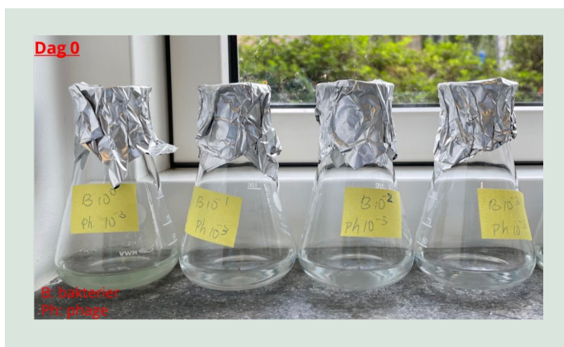
FIGUR 63. Et udsnit af prøver ved forsøgsstart (dag 0). Væsken var svag grønlig i prøverne med den højeste koncentration af blågrønalger tilsat (B 10 0 ) og klar i de øvrige prøver.
