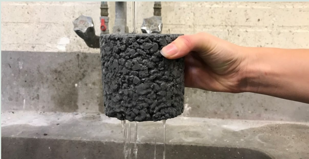
FIGUR 1. Permeabelt betonprøveemne hvor der løber vand igennem.
