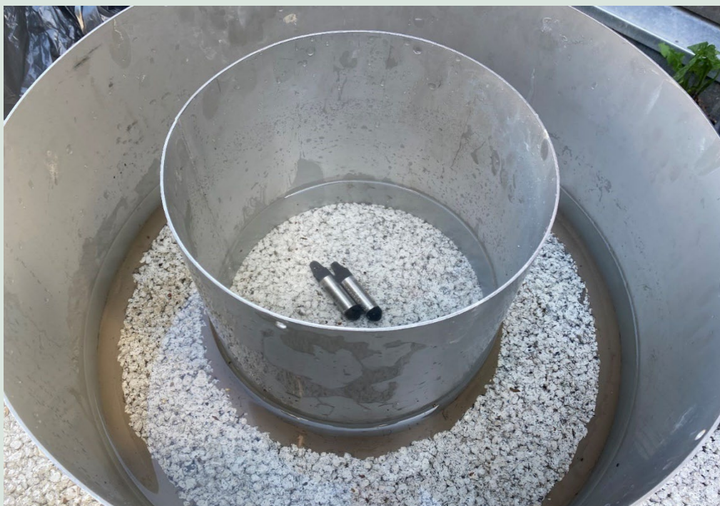
FIGUR 8. Eksempel på forsøgsopstilling til on-site test af permeabilitet.
