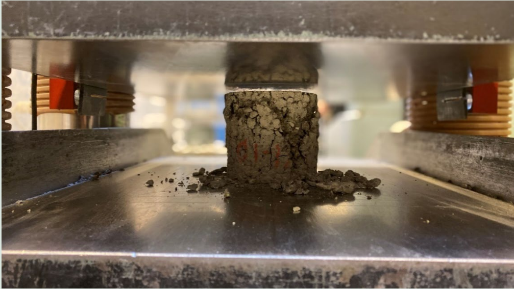
FIGUR 10. Eksempel på trykprøvning af permeabel betonprøve.
