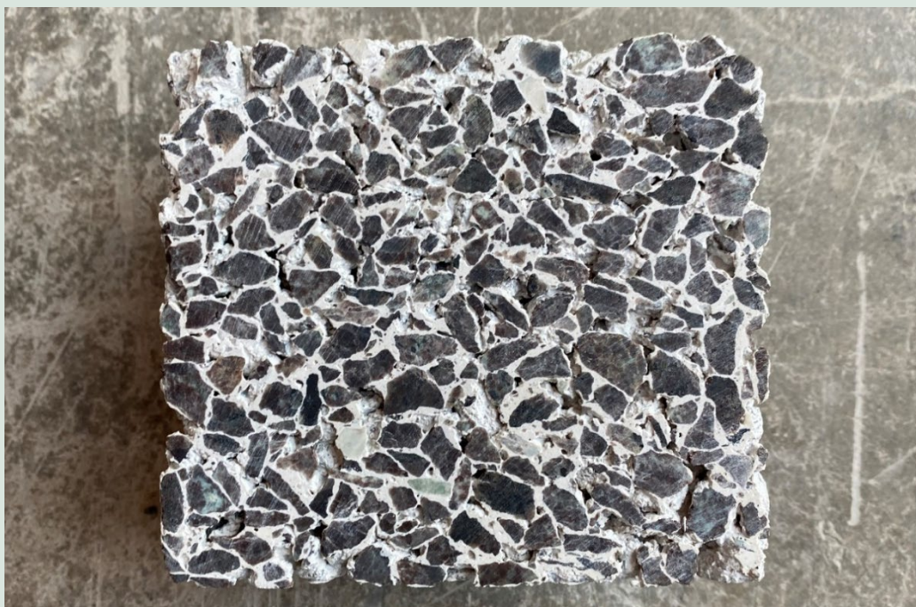
FIGUR 3. Permeabelt betonprøveemne med hvid cement, som er skåret over.
