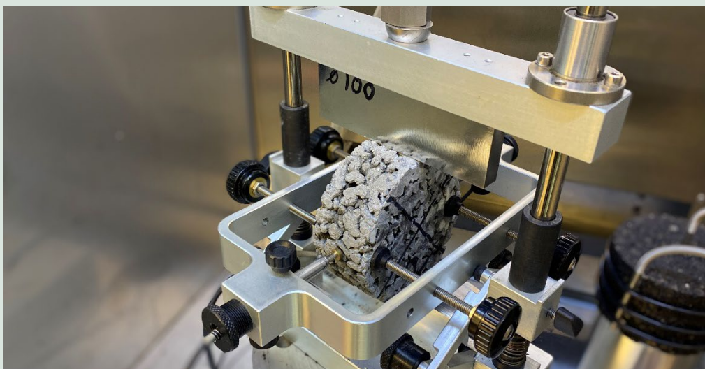
FIGUR 12. Forsøgsopstilling anvendt til test af E-modul efter asfaltmetoden.
