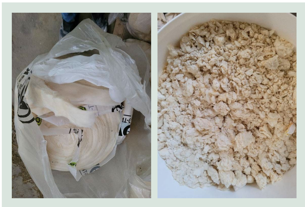
FIGUR 20. Billeder af glasuldmaterialet før neddeling (venstre) og efter neddeling (højre) i en skruekomprimator fra Runi.
