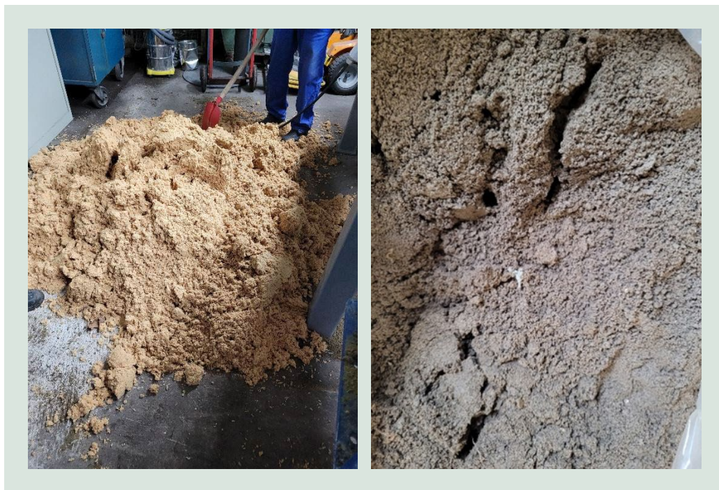
FIGUR 16. Billeder af glasuld (venstre) og stenuld (højre) efter neddeling i en skruekomprimator fra Hansek Maschinenbau.
