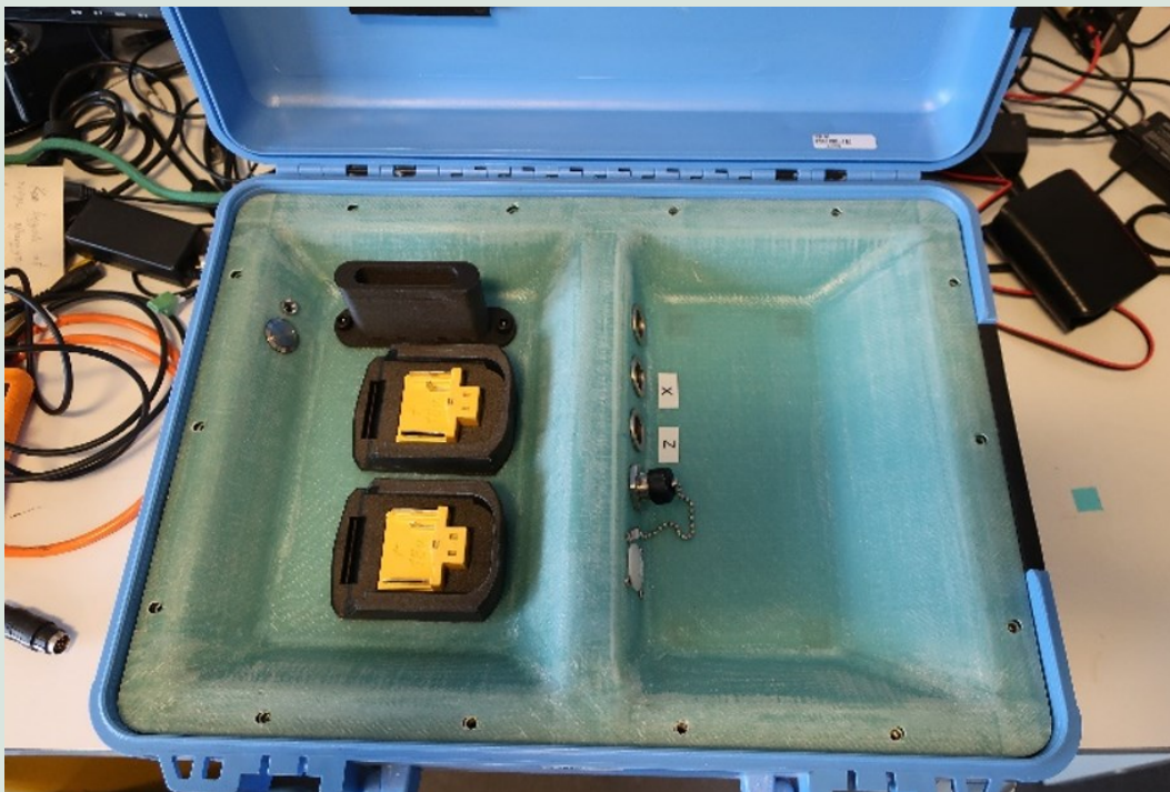
FIGUR 9. Harddiskholder og dobbelt batteriholdere til standard 18 V makita-batterier muliggør, at projektgruppen kan undlade at skulle sende batteri med som farligt gods.
