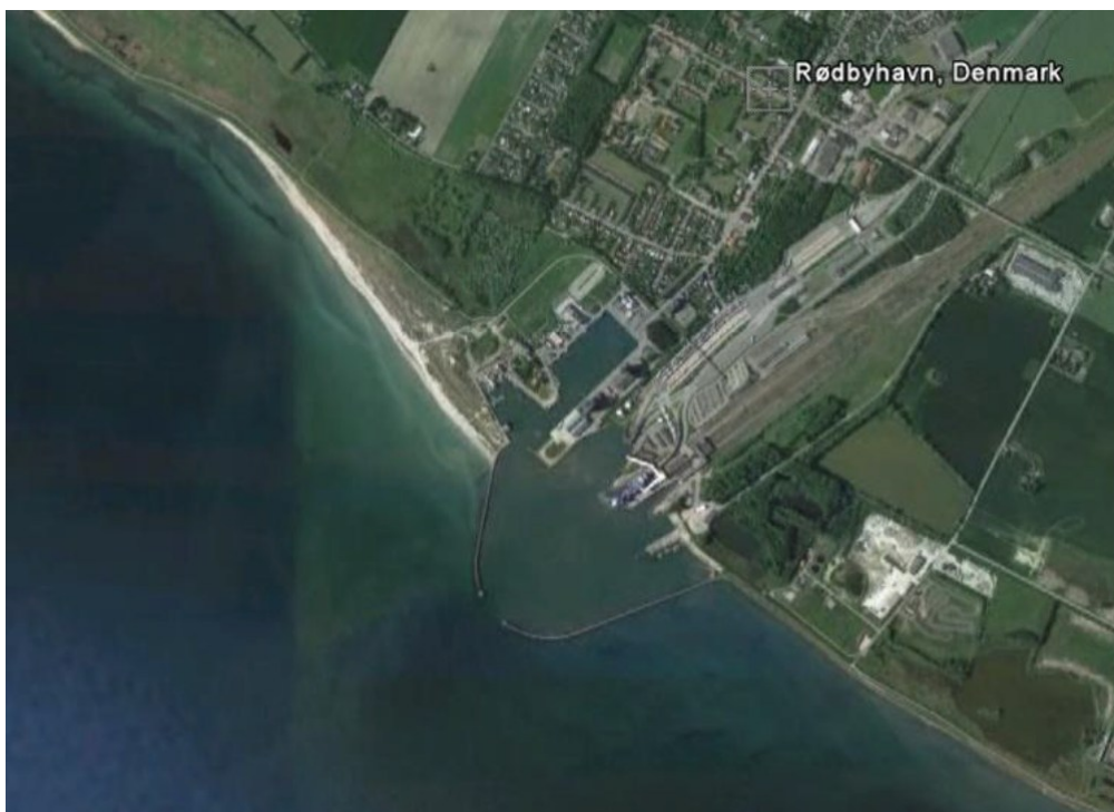
Figur 4.15 Luvside tilsanding nordvest for Rødbyhavn, hvor der er en netto langstransport på ca. 30.000 m 3 /år imod sydøst fremkaldt af fremherskende bølger fra vestlige retninger. Området sydøst for havnen er omvendt under erosion.
