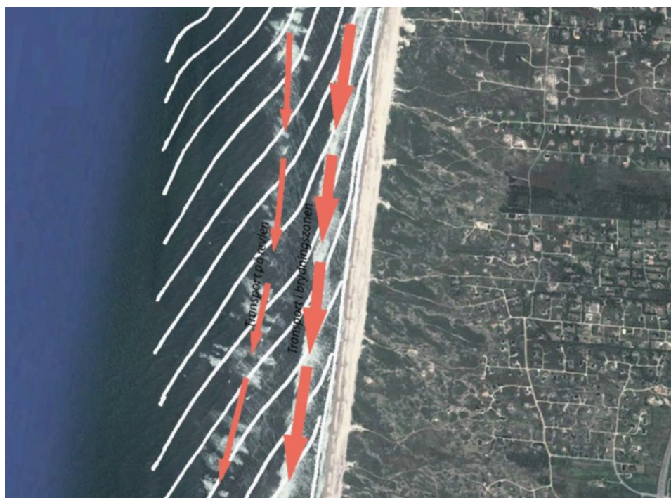
Figur 4.9 Bølger, som slår ind på en strand og driver en langsgående transport. Hvide linjer viser bølgetoppe. Orange pile indikerer langtransportens retning og størrelse.
