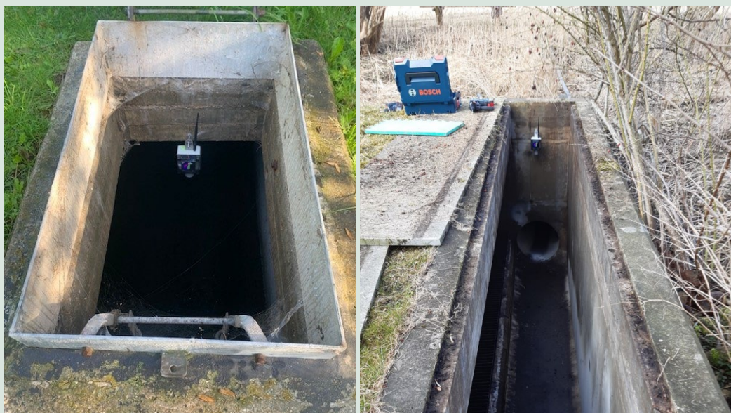
FIGUR 19. Dryp niveaumålere opstrøms og nedstrøms overløbskanten.
