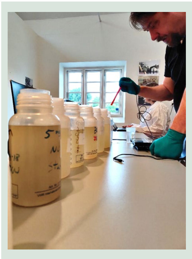
FIGUR 71. Online sensorer bliver testet på fortyndingsrække mellem spildevand og overfladevand.
