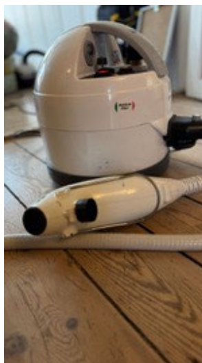
Dampmaskine, der ofte anvendes til dampbehandling af væggelus.
