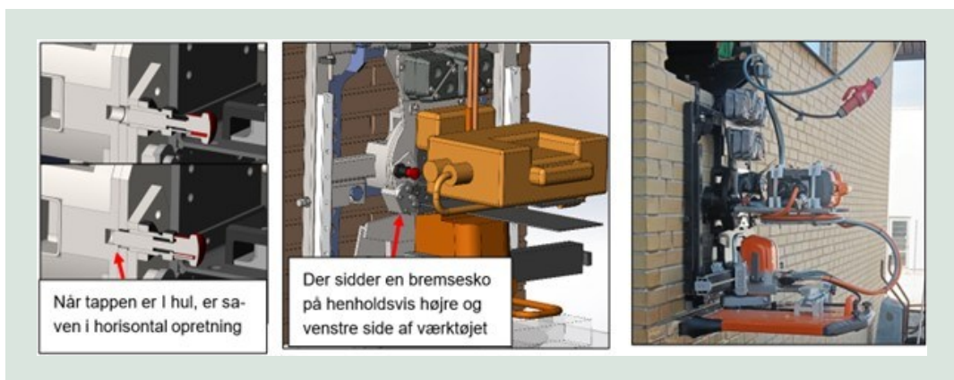
FIGUR 3.7. Til venstre ses et tværsnit af fjederbelastede låsetappe som aktiveres, hvorved den horisontale opretning er sikret. I midten ses en visualisering af den ene af de to bremsesko, som låser saven fast til skærerammen. Til venstre ses et billede af hvordan det horisontale snit skæres først.
