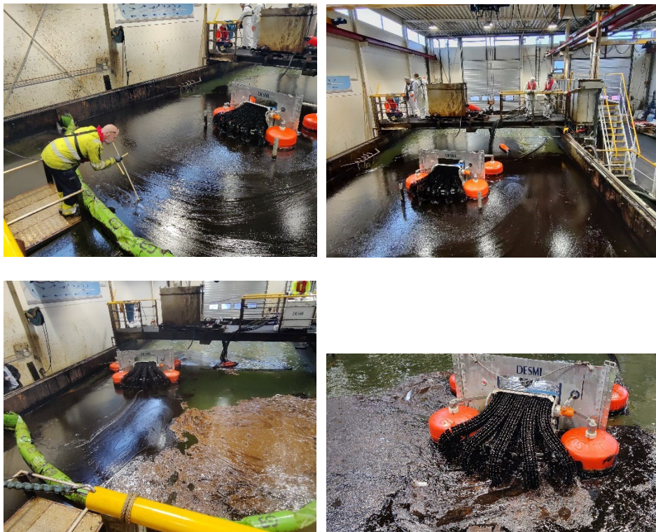
Prototype Octopus LSFO skimmer testet i Horten oktober 2024.
