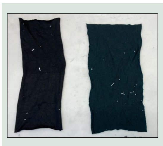
FIGUR 5.4. Tekstilprøver efter behandling med hvide rester fra bindingsmidlet.
