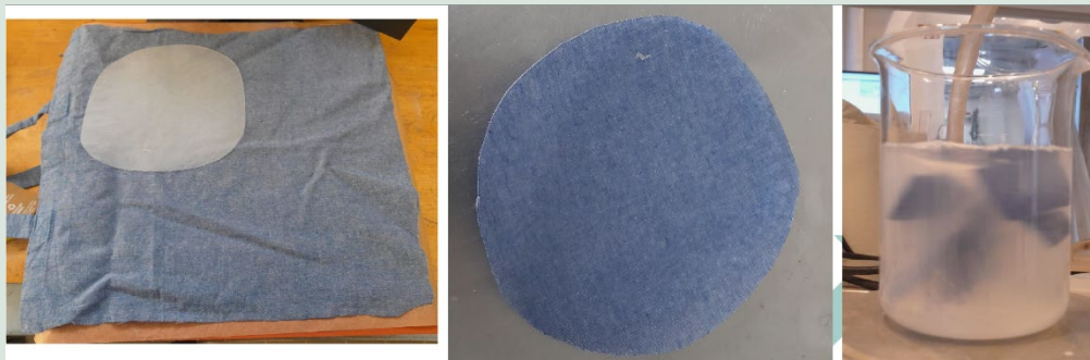
FIGUR 6.5. Billeder af et proof-of-concept transfertryk lavet med den identificerede polymertype (venstre, midt), og opløsning af dette via det udviklede triggersystem (højre).
