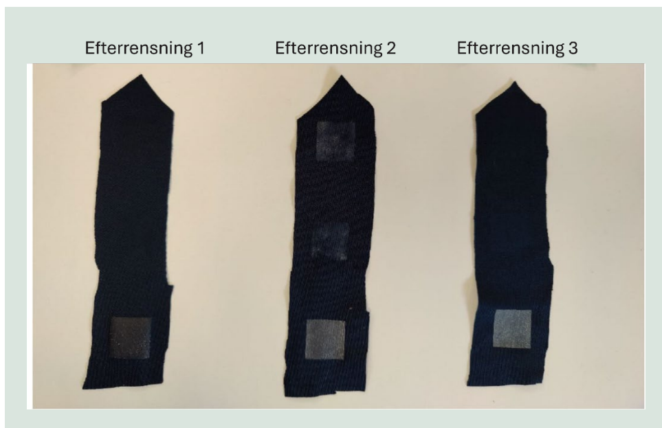
FIGUR 5.8. Tekstilprøver efter behandling og rensning med tre forskellige efterrensningsmetoder.
