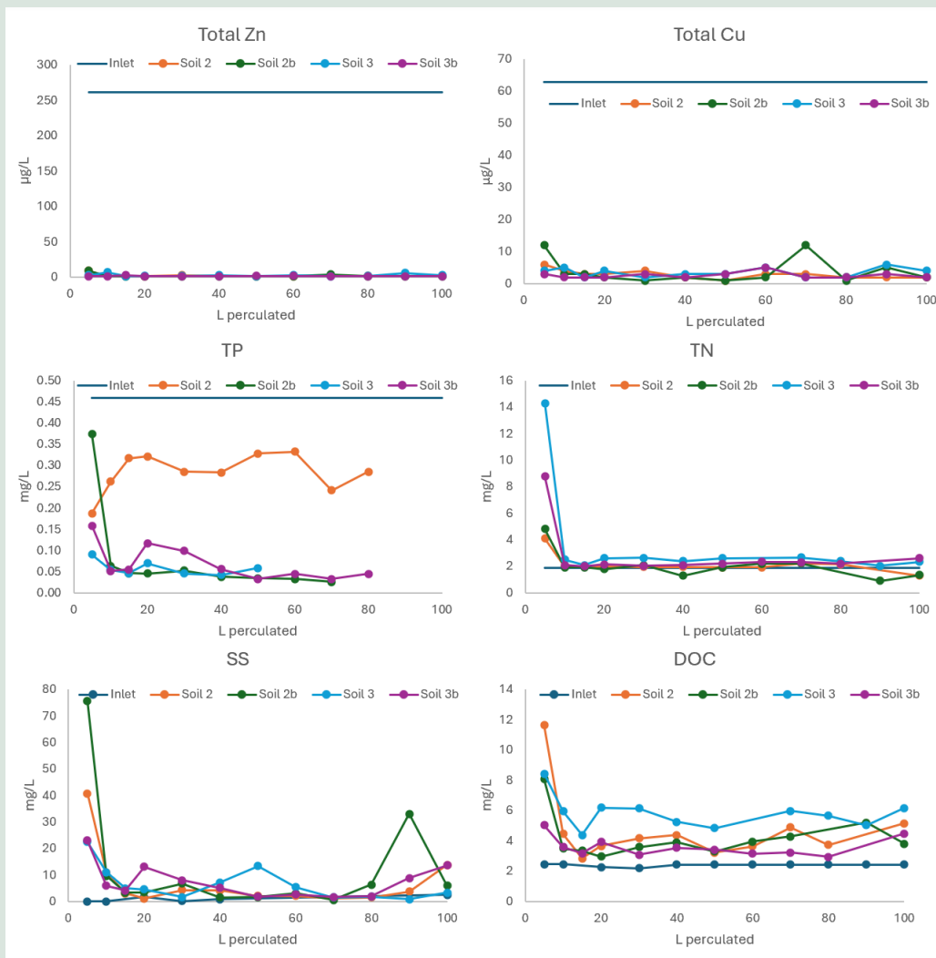
FIGUR 5.2. Søjleforsøg, der tester fire forskellige jordrecipienter ved at perkulere indløbsvand med kendte koncentrationer gennem materialerne. Koncentrationer er vist for total Zn og Cu, TP, TN, SS og DOC.
