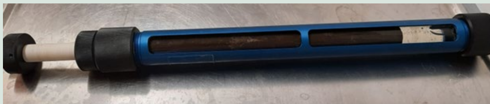
FIGUR 5.31. viser filterkolonne med kollapsed jord.
