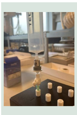
FIGUR 2. Montering af SPE-kolonner på manifold i forbindelse medkonditionering og loading.
