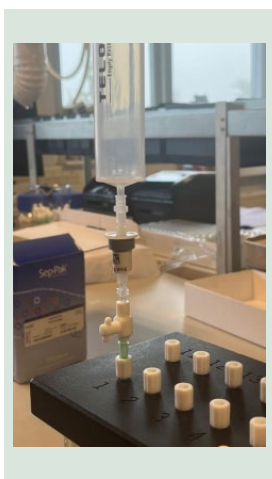
FIGUR 1. Montering af SPE-kolonne på manifold i forbindelse med vask af kolonnen samt eluering.
