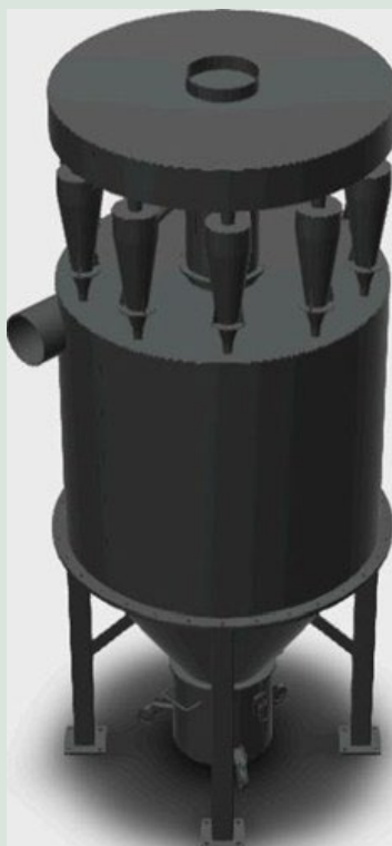
FIGUR 2. TV ses multicyklonen opsat i driftsmiljøet. TH ses en model af multicyklonen.
