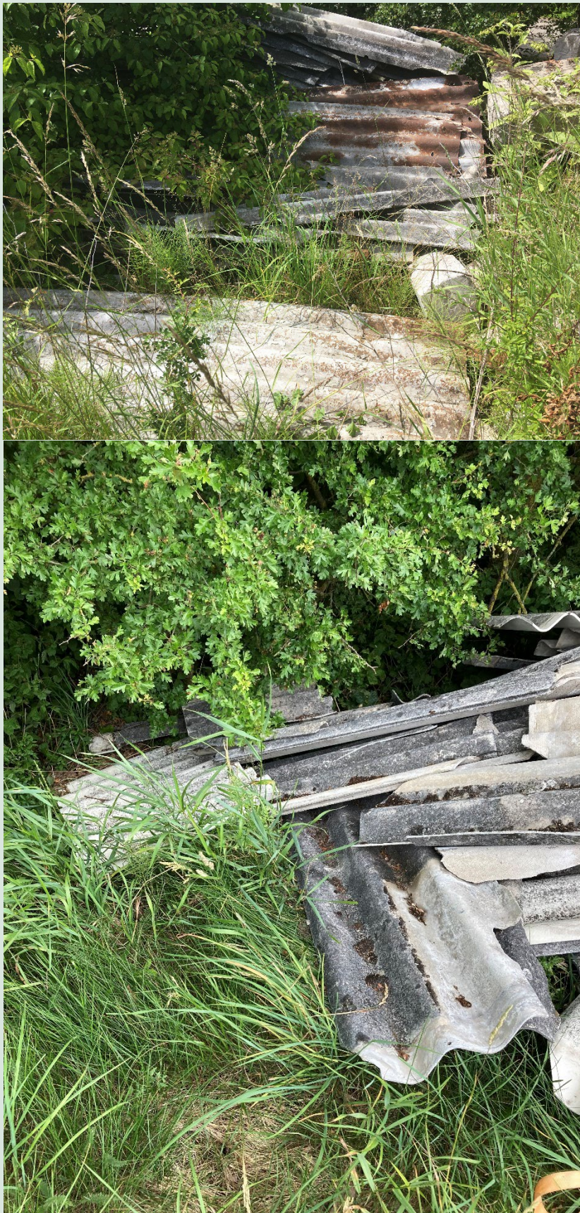
FIGUR 4. Eksempler på asbestholdigt materiale i/på jord. Billeder er fra Aalborg kommune
