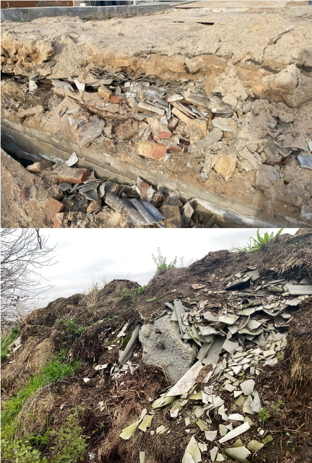
FIGUR 5. Eksempler på asbestholdigt materiale nedgravet i jorden. Billeder er fra Aalborg kommune
