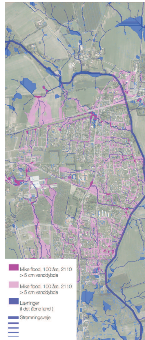
Figur 5. Potentielle oversvømmelser vist vha. MIKE FLOOD kortlægning (violet), blue spot og strømningsveje (blå)
