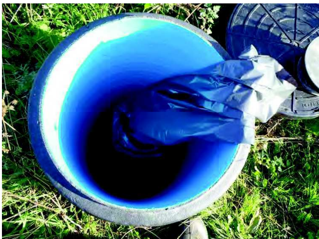
Foto 17: Måling af gasflow fra en gasindvindingsboring ved en såkaldt "posemåling". Posemålingerne giver et groft skøn af gasflowet.
