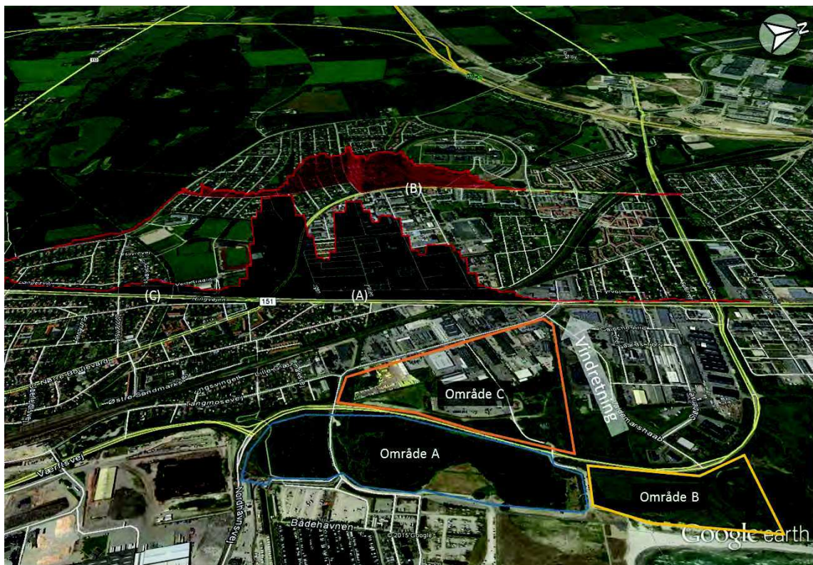
Figur 4. Målte koncentrationer nedvinds deponiet observeret 25. juli, 2015. Den røde kurve illustrerer målte koncentrationer af metan over baggrunds niveau (1,889 ppm) og er ganget med 4000 for at være synlig på kortet.
