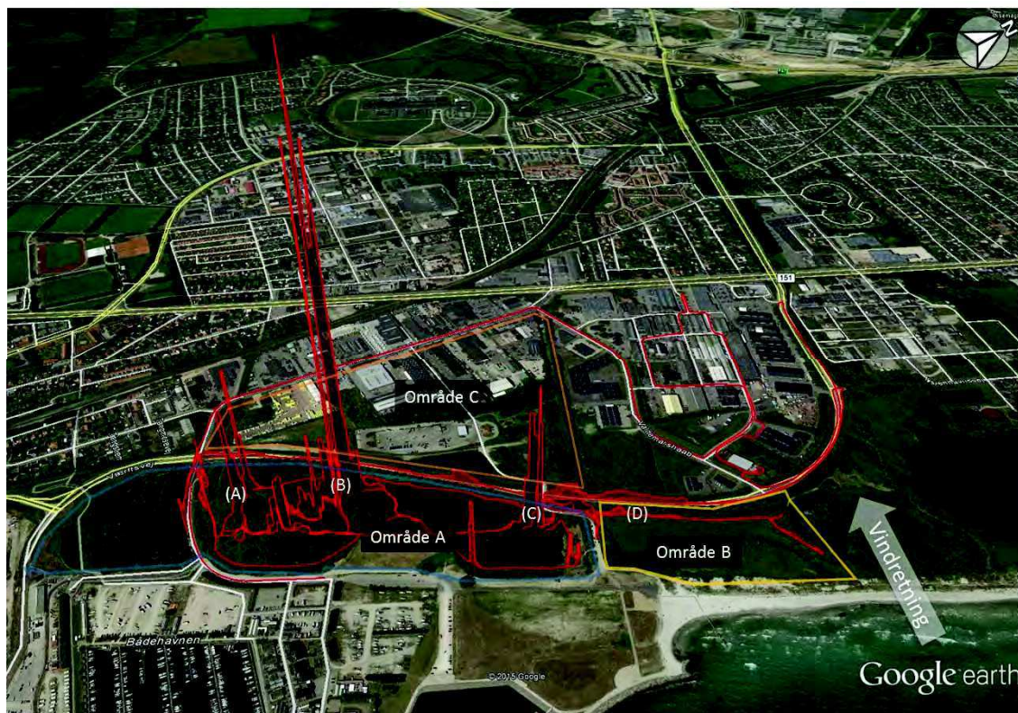
Figur 5. Screening af metankoncentrationer på Køge deponi 17. august, 2015 (område A) og 19. august (område B og C). Den røde kurve illustrerer målte koncentrationer af metan over baggrunds niveau (1,900 ppm) og er ganget med 100 for at være synlig på kortet.
