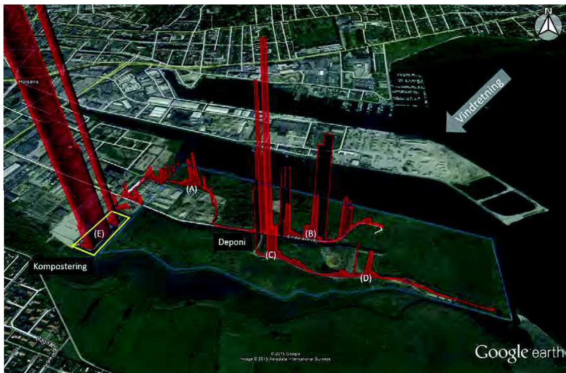
Figur 3. Screening af metankoncentrationer på Horsens Deponeringsanlæg 13. oktober, 2015. Deponiet og området til kompostering er fremhævet. Den røde kurve illustrerer målte koncentrationer af metan over baggrunds niveau (1,975 ppm) og er ganget med 200 for at være synlig på kortet.
