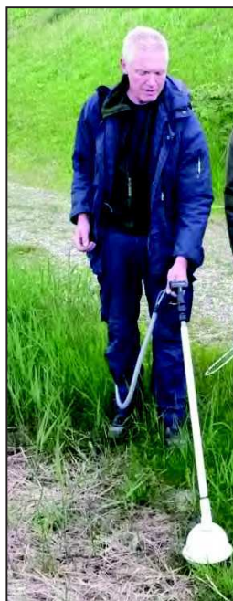
Figur 2 Overfladescreening med FID-måler. Sonden er påmonteret en såkaldt "kop" for at opnå et afgrænset prøvolumen og for at skærme sonden mod vind og vejr.
