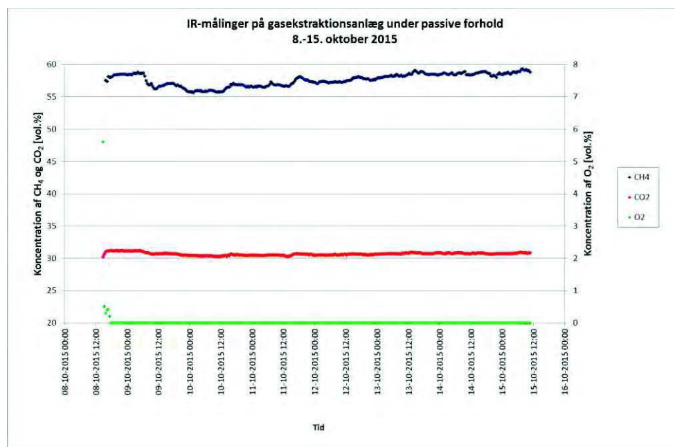
Figur 5 Resultater af IR-målinger udført den 8.-15. oktober 2015 under passive forhold, dvs. med gasekstraktionsanlægget ud af drift. Bemærk, at koncentrationerne af metan og kuldioxid er angivet på y-aksen til venstre, mens koncentrationen af ilt er angivet på y-aksen til højre. Grafen er gengivet fra bilag 6.2.
