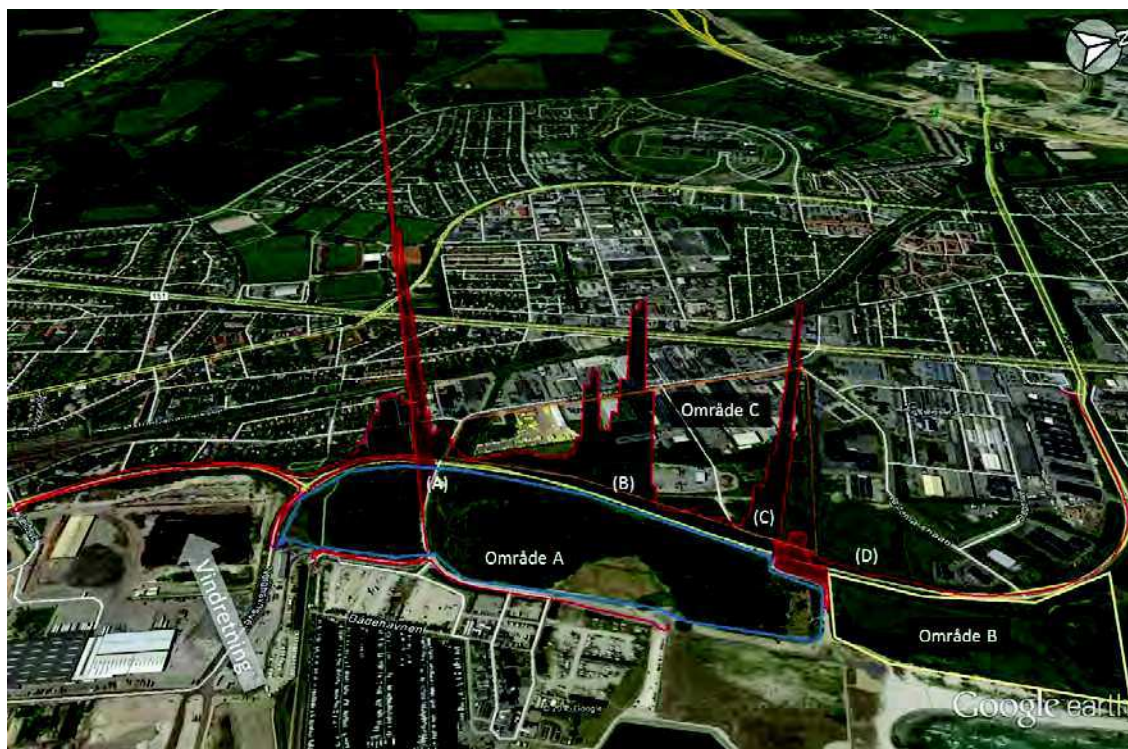
Figur 3. Screening af metankoncentrationer i deponiets omgivelser udført 25. juli, 2015. Den røde kurve illustrerer målte koncentrationer af metan over baggrundsniveau (1,889 ppm) og er ganget med 200 for at være synlig på kortet.
