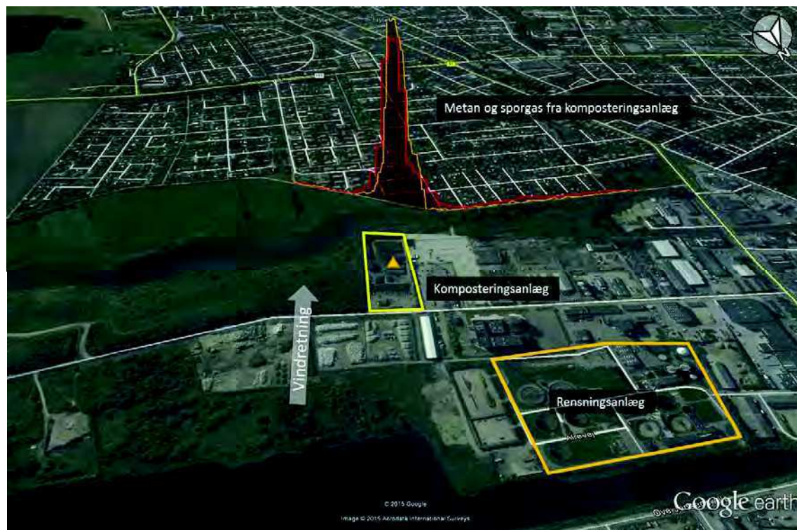
Figur 8. Eksempel på måling af metan og sporgaskoncentrationer nedvinds for komposteringsanlægget under måling af den totale metanemission 13:56. Den røde kurve illustrerer målte koncentrationer af metan over baggrunds niveau (1,935 ppm) og er ganget med 300 for at være synlig på kortet. Den gule kurve illustrerer målte koncentrationer af sporgas (acetylen) og er ganget med 15. Den gule trekant markerer, hvor der blev frigivet sporgas.
