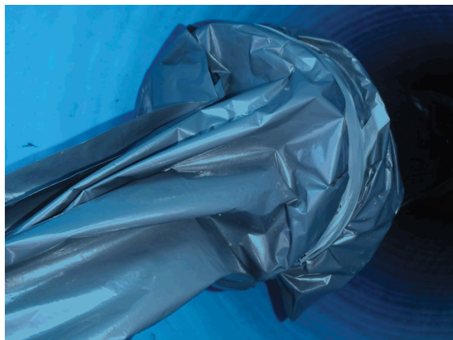
Foto 18: "Posemåling". 90 liters pose monteret på afslutningen af en gasindvindingsboring.
