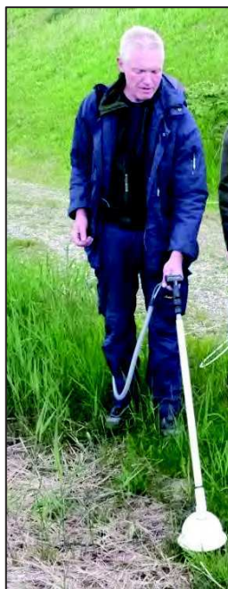
Figur 2 Overfladescreening med FID-måler. Sonden er påmonteret en såkaldt "kop" for at opnå et afgrænset prøvevolumen og for at skærme sonden mod vind og vejr. Selve FID-apparatet bæres på ryggen.
