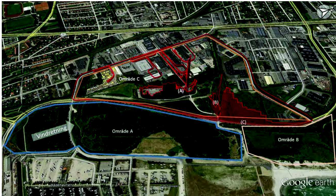
Figur 6. Screening af metankoncentrationer på Køge deponi (område C) 3. november, 2015. Den røde kurve illustrerer målte koncentrationer af metan over baggrundsniveau (2,069 ppm) og er ganget med 100 for at være synlig på kortet.
