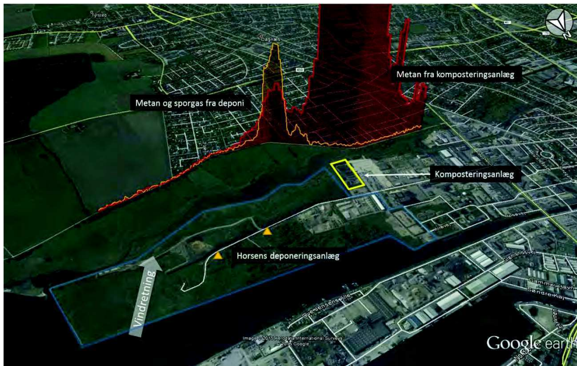
Figur 5. Eksempel på måling af metan og sporgaskoncentrationer nedvinds for deponiet. Den røde kurve illustrerer målte koncentrationer af metan over baggrunds niveau (1,910 ppm) og er ganget med 6000 for at være synlig på kortet. Den gule kurve illustrerer målte koncentrationer af sporgas (acetylen) og er ganget med 40. De to gule trekanter markerer, hvor der blev frigivet sporgas.
