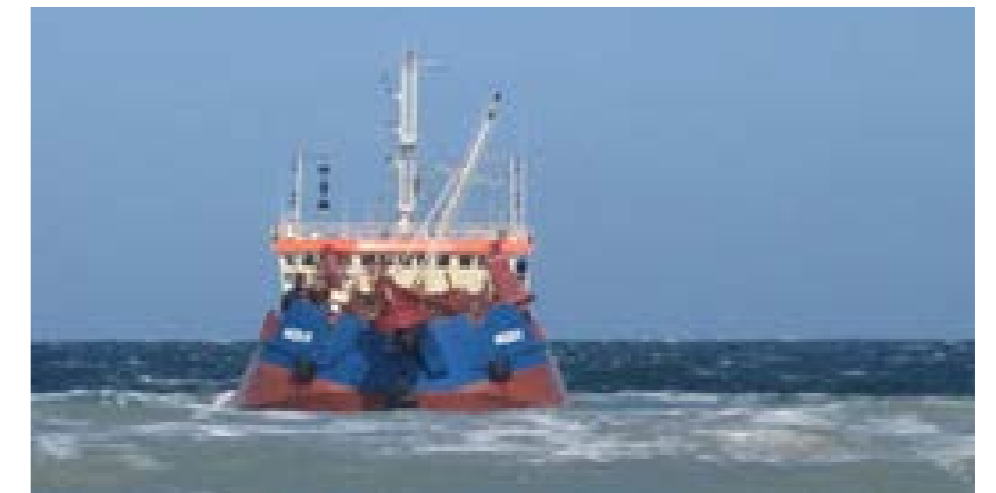
Skib i færd med at klappe sand til havbunden. På billedet ses hvordan skroget splitter.
