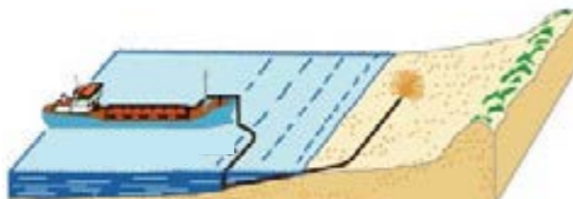
Indpumpning med bundliggende rørledning, hvor sandet fordeles parallelt med stranden.
