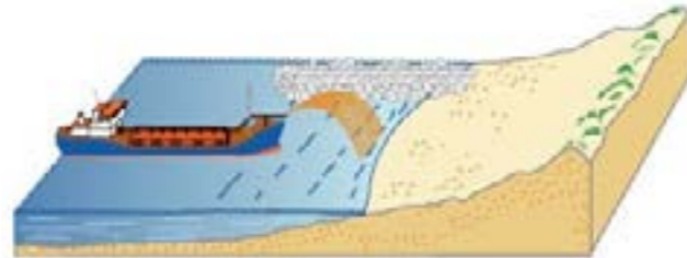
Principtegning af rainbowing.
