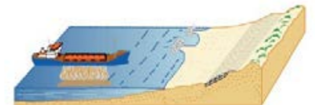
Skib i færd med at klappe sand til havbunden. På billedet ses hvordan skroget splitter.
