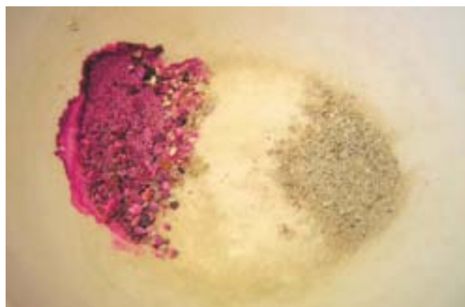
Foto 3.1 phenolphthalein behandlede prøver af karbonatiseret og ikke-karbonatiseret beton
