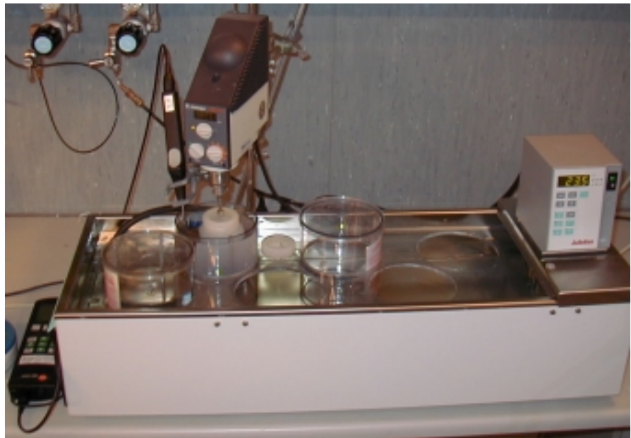
Figur 3.1: Test opstilling for måling af kobberudledning med ISO 15181. Bemærk reference termometret til venstre for badet og føleren der er placeret i selve karret med kunstigt havvand. De 3 af 6 positioner er anvendt for at opnå temperatur ligevægt.
