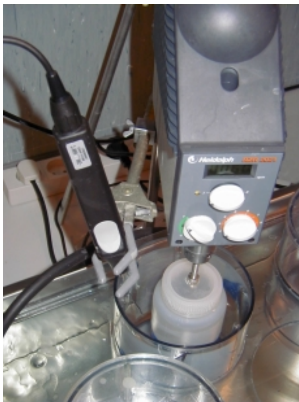
Figur 3.2: Test opstilling for måling af kobberudludning med ISO 15181. Heidolph motoren kan justeres fra ca.30 rpm til ca. 2000 rpm med elektronisk udlæsning af den aktuelle omdrejningshastighed.
