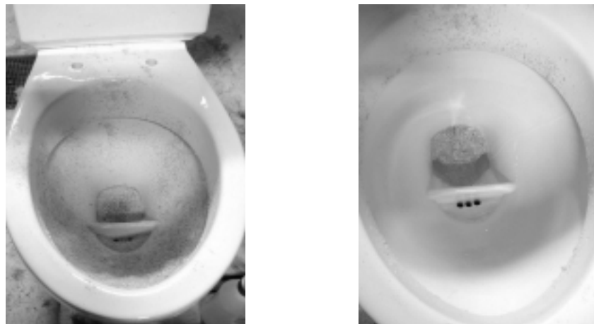
FIGUR 10.1 Klosetskål dækket af savsmuld, der skal skylles bort ved et vandskyl.
