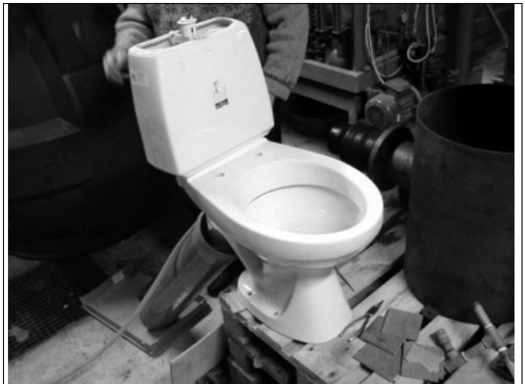
FIGUR 1. Forsøgsopstilling med Porsgrund wc.
