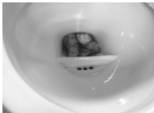
FIGUR 10.2 Klosetskål før skyldning med 4 svampe.
