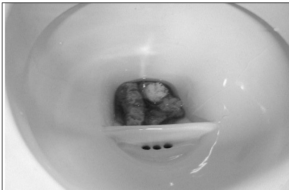
FIGUR 6 Fækaliedel fyldes med 4 stk. natursvampe inden skyllevandsmekanismen aktiveres.
