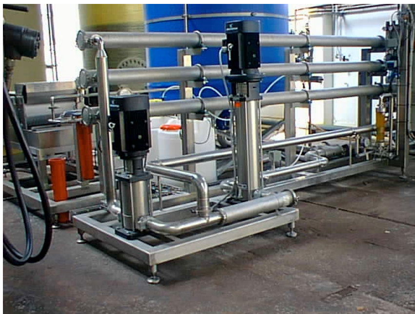
Figur 17: Membranlæg. I baggrunden opsamlings- og CIP-tanke.
