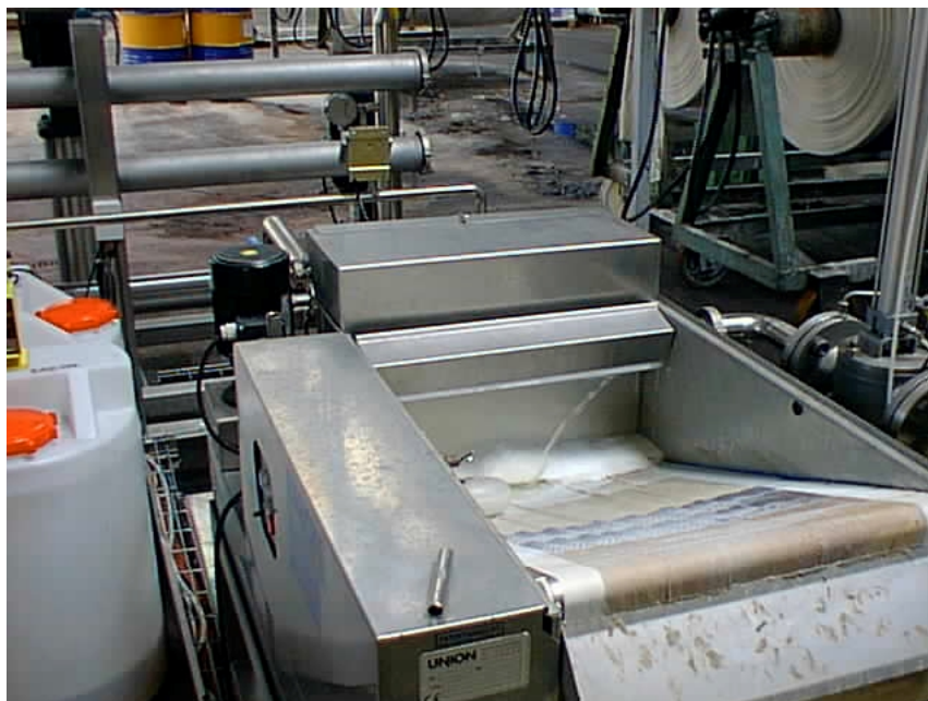
Figur 16: Båndfilter. Til højre ses toppen af det selvrensende forfilter.
