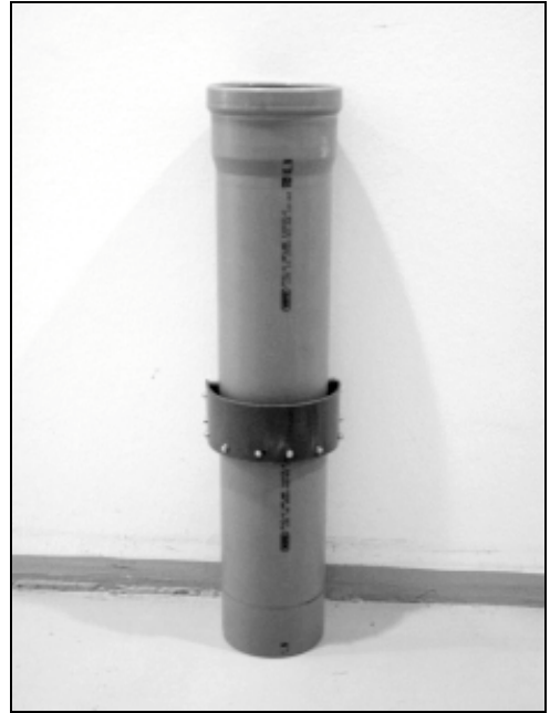
Foto 4-4: Forskudt samling på ø110 mm PVC-rør.
