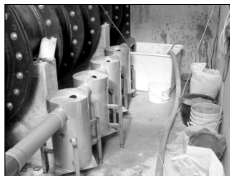
Foto 4-2: Spildevand cirkuleredes gennem fire stålsøjler i opstilling F1.
