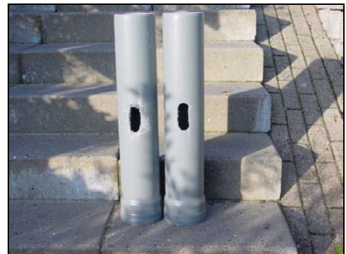
Foto 4-7: Kunstige tæring i bunden af ø110 PVC-rør.
