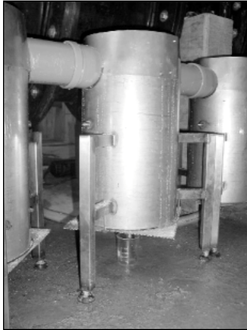
Foto 4-3: Stålsøjle, opstilling F1. Under søjlen opsamles prøven.
