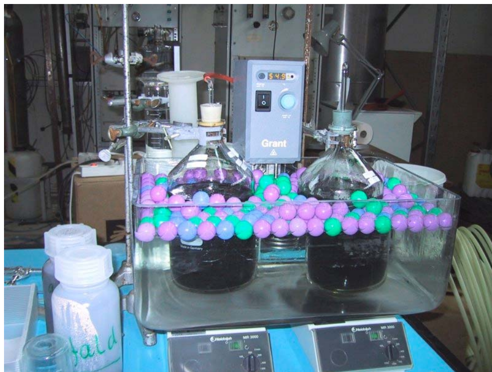
Billede 1 Laboratorieopstilling til bioforgasning af bionedbrydelige plastposer
