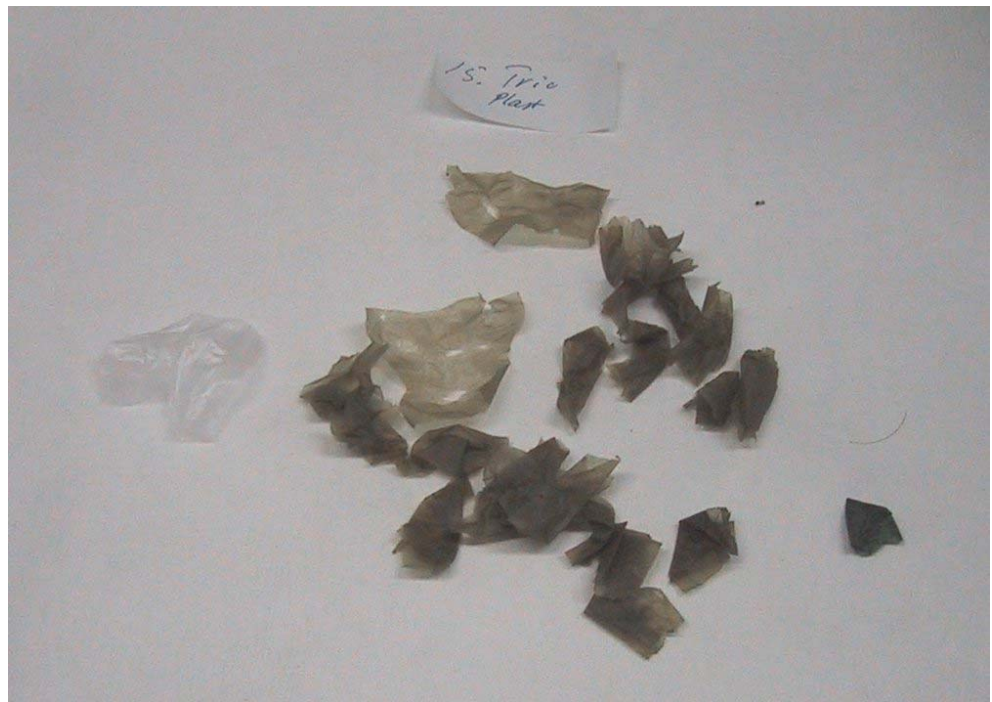
Billede 2 Strimler af poser fra Trioplast/Biotec før og efter bioforgasning i laboratoriereaktor
