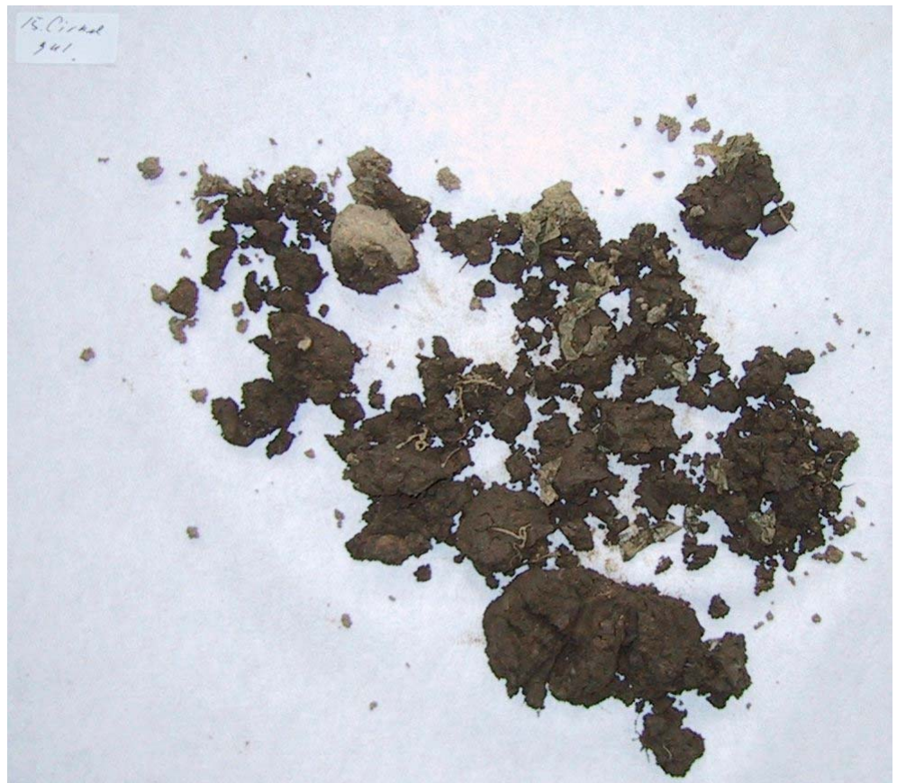
Bil lede 8 Resultat af nedbrydning i jord for pose nr. 3 (Sækko/Mater-Bi, 90°C)
