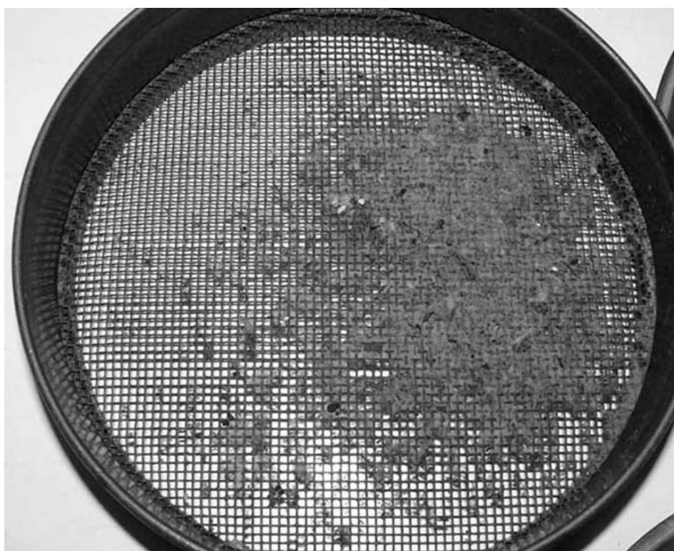
2 mm sikten efter torkning. Uppvägt material (grus, organiskt material) 1 g
