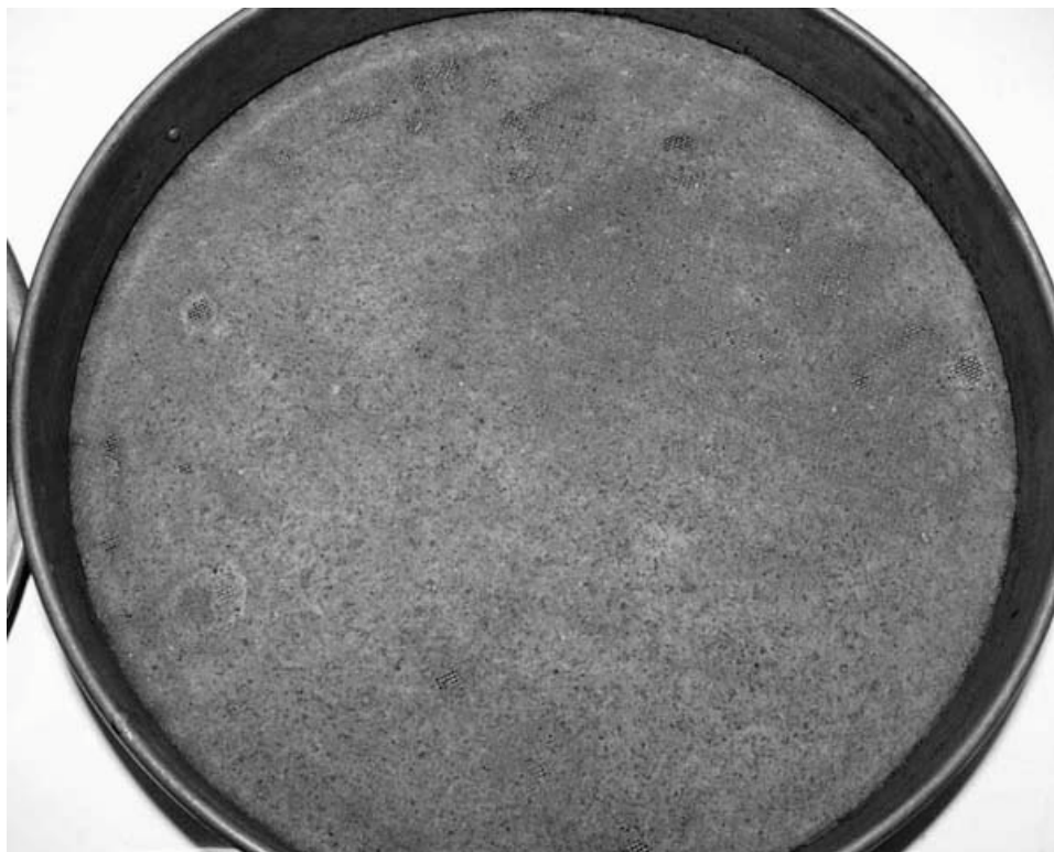
0,5 mm sikten efter torkning. Uppvägt material (grus, organiskt material) 5,6 g
